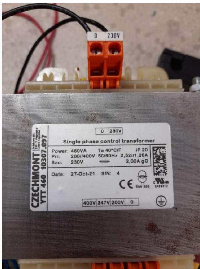
Obrázek č. 11 – Štítkové hodnoty Scottova transformátoru
