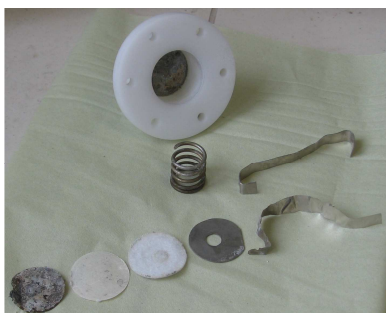
Obrázek 3: celá pro měření vlastností Zn elektrod, z levého dolního rohu doprava: měřená elektroda, separátor 1, separátor 2, protielektroda
