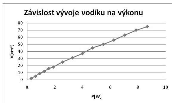
Obr. 3: Závislost vývoje vodíku na výkonu
