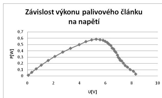
Obr. 6: Závislost výkonu palivového článku na napětí
