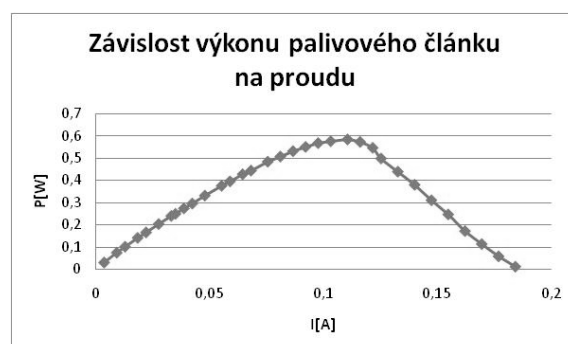
Obr. 5: Závislost výkonu palivového článku na proudu
