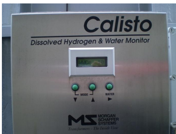
Obr. 3: Základní typ senzoru Calisto
