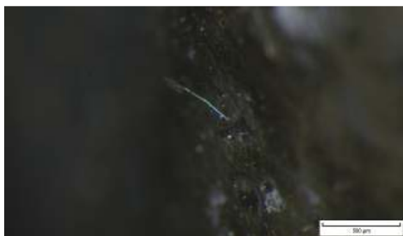
Obr. 7: Snímek z optického mikroskopu, cínový whisker délky 511 \mu\text{m} z povrchu Sn-1Cu.
