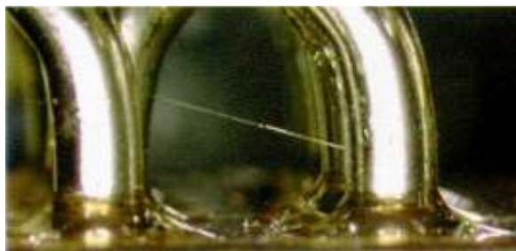
Obr. 1: Whisker rostoucí z jednoho vývodu směřující k druhému vývodu [12].
