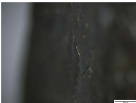
Obr. 8: Snímek z optického mikroskopu, cínový whisker délky 231 \mu\text{m} z povrchu Sn-0,7Cu.
