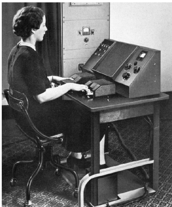
Obrázek 2.3: Helen Harperová obsluhující elektronický syntetizér Voder 1
