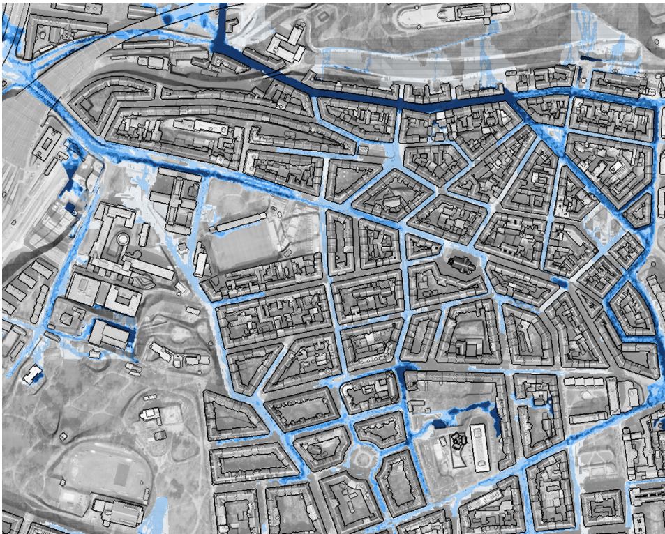
Obr. 5.8 Mapa hloubek zaplavení ulic vývěrem z kanalizace a proudění uličním profilem z výsledku simulačního modelu. Zdroj: Metelka & Urban, 2022
