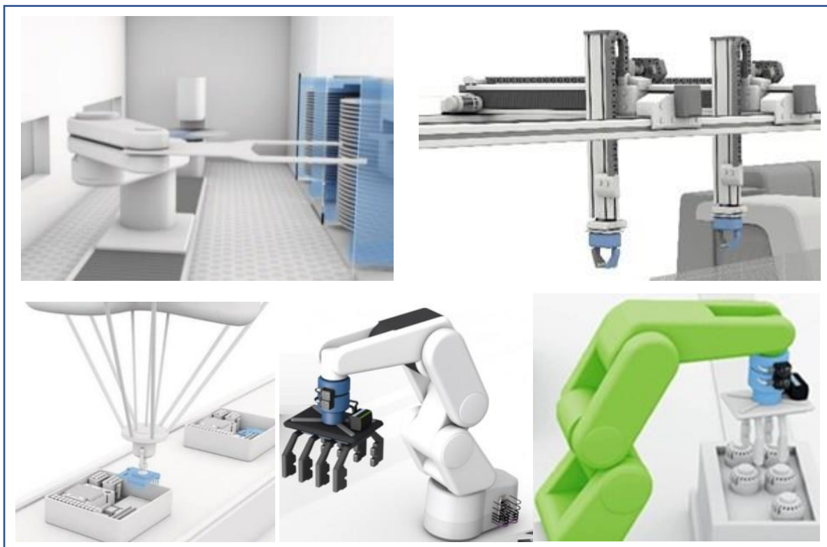
Obrázek 2-5- Typické roboty s pevnou základnou: SCARA, Kartézský/Portální, Paralelní/Delta, Kloubový robot, Kobot [34]
