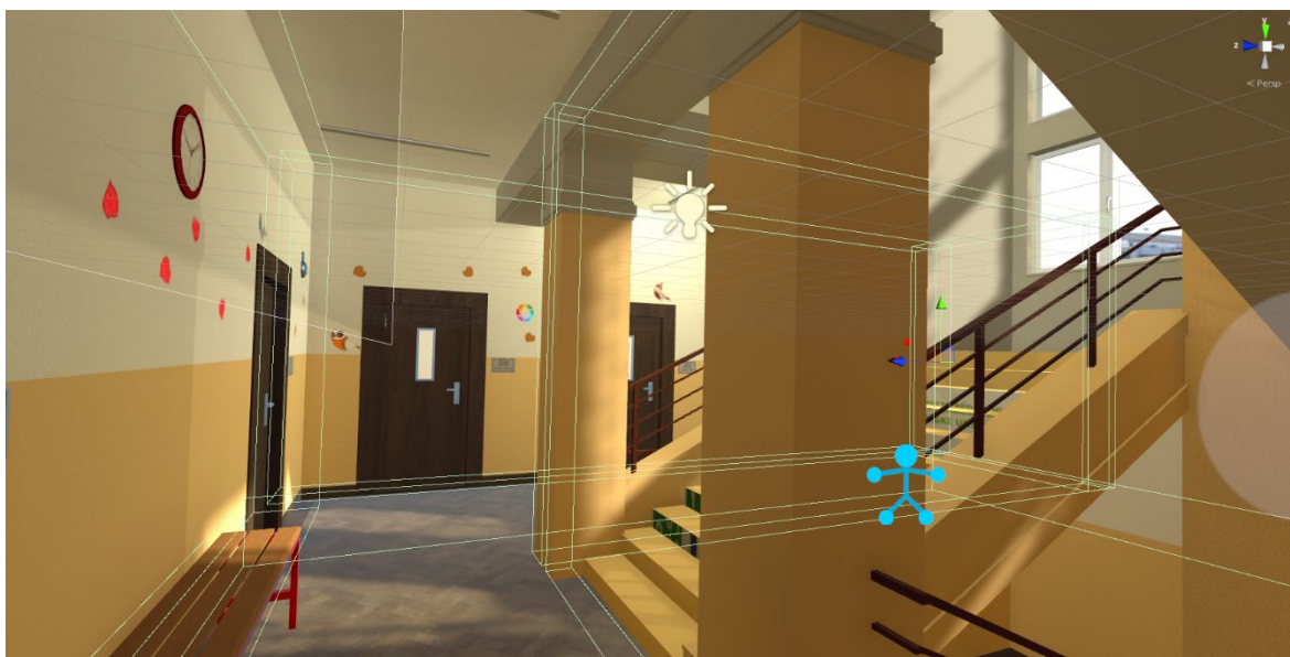
Obrázek 17 - collidery uvnitř chodby
