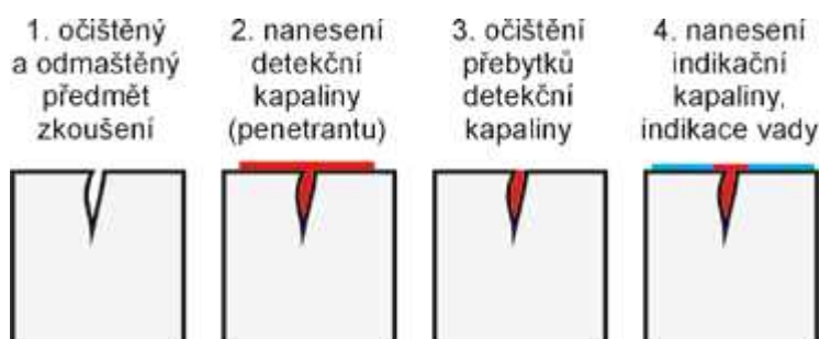
Obr.P4-6 Princip kapilární defektoskopické zkoušky [87]
