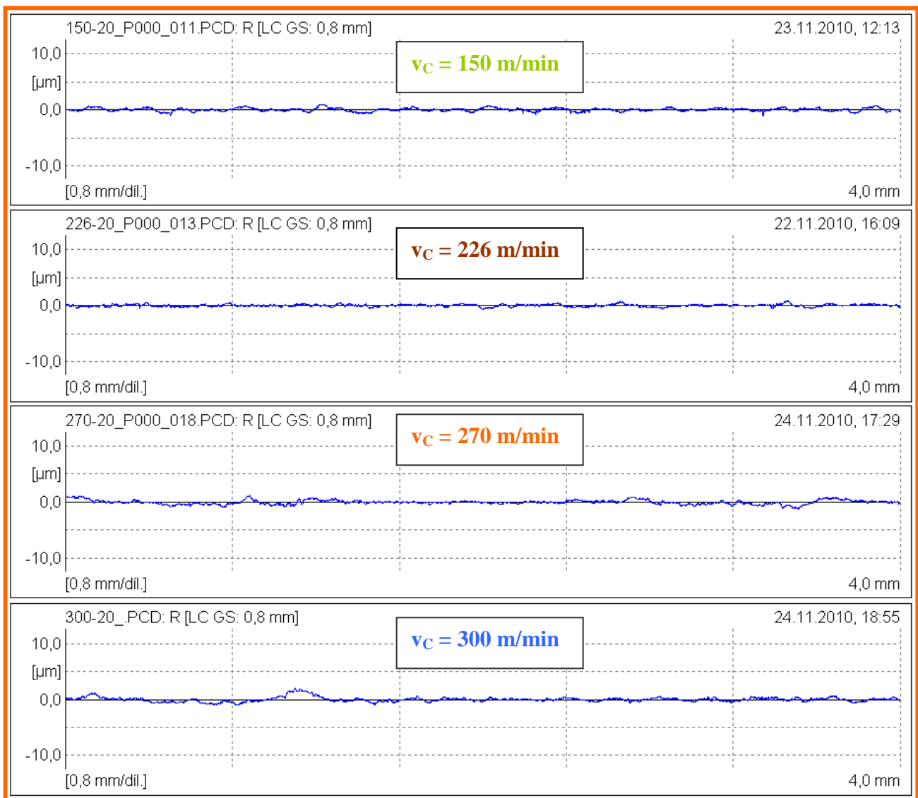
Obr.P5-11 Porovnání profilů obroběného povrchu v závislosti na zvyšující se řezné rychlosti v c ; f z = 4,5 mm; V = 6 cm³; IN2004
