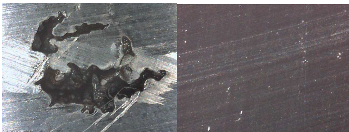
Obr. P4-5 Makroskopická vada v reálném tělese (vlevo) a mikroskopické vady v experimentálním obrobku
