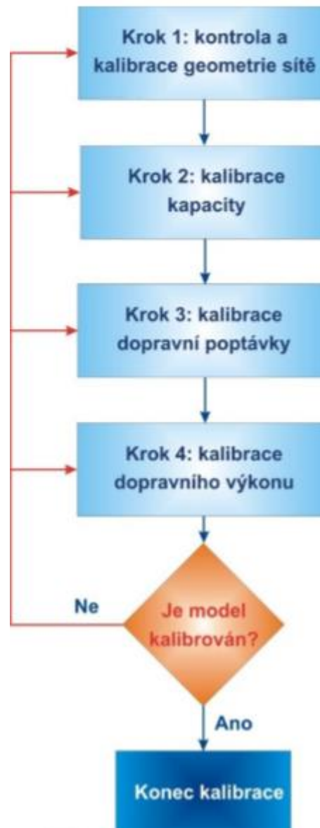
Obrázek 4.1 Postup kalibrace mikroskopického modelu dle [8].
