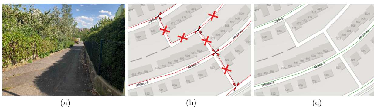
Obrázek 2.4: Odstranění účelové komunikace. a) skutečný stav , b) základní dopravní model , c) editovaný dopravní model
