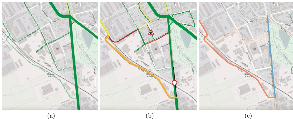
Obrázek 2.12: Ukázka vizualizace ve webové aplikaci TraMod. a) výchozí dopravní model, b) dopravní model s dopravním scénářem, c) diferenční dopravní mapa
