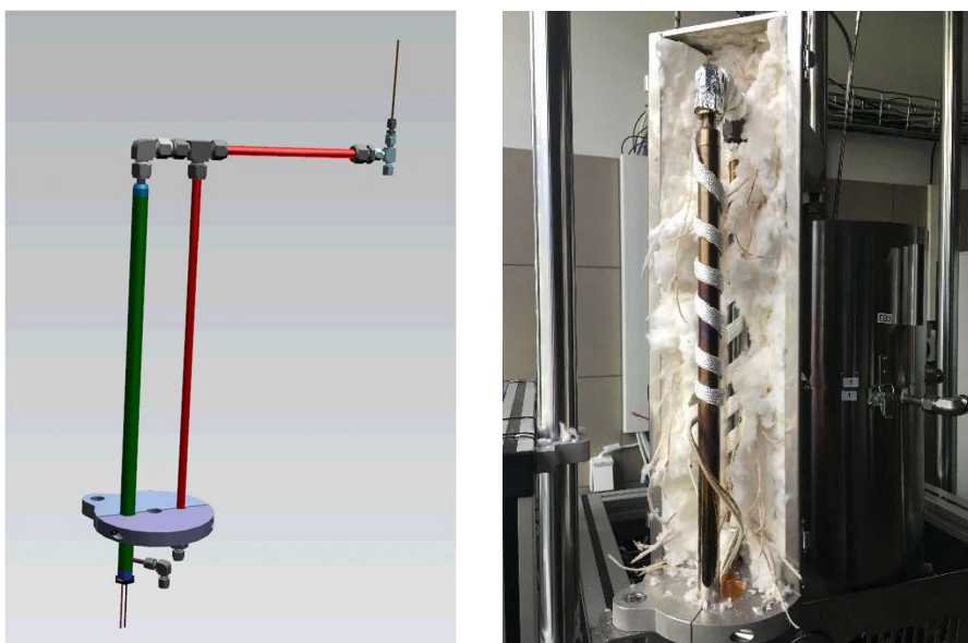
Obrázek 41: Parogenerátor a směšovač s paralelní potrubní větví s Varigonem.
