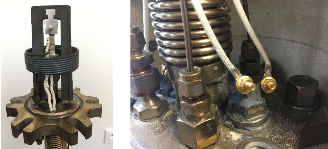
Obrázek 55: Izolace drátů uvnitř korozní cely pomocí keramických korálků a vodivé napojení na kabeláž DCPD vývodů pomocí pozlacených šroubů a matic.
