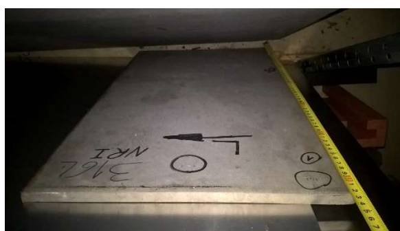
Obrázek 44: Plát oceli 316L, ze kterého byly vyrobeny vzorky.
