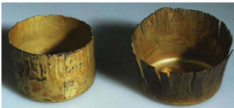
Obrázek 14: Příklad korozního praskání v mosazi způsobené čpavkem. [77]
