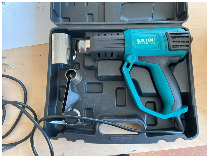
Obrázek 21 - Horkovzdušná pistole použitá při lepení zkušebních vzorků
