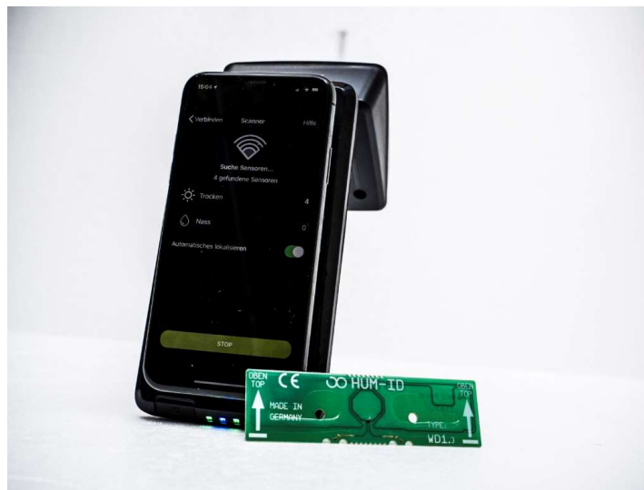
Obrázek 12 - systém detekce zatékání do plochých střech [29]
