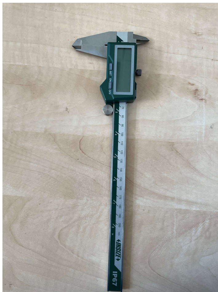
Obrázek 16 - Digitální posuvné měřítko, které bylo využíváno při měření rozměrů vzorků
