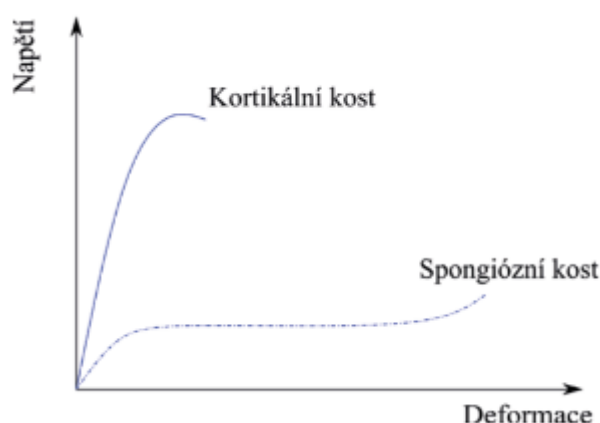
Obrázek 13 Závislost napětí na deformaci pro spongiózní a kompaktní kost při kompresním zatížení [2]
