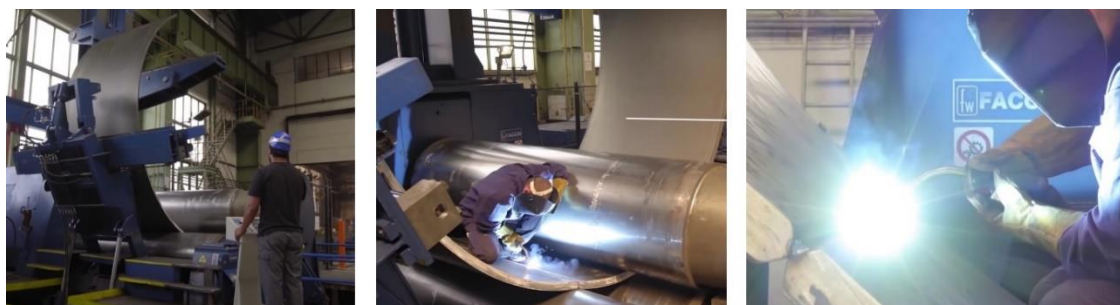
Obrázek 20: Výroba kroužku zakružováním z plechu [9]
