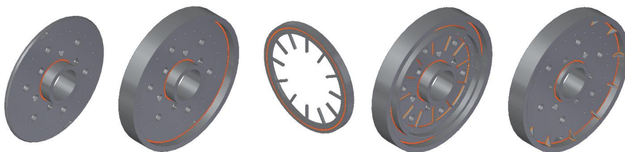
Obrázek 34: Postup svařování dílů kola
