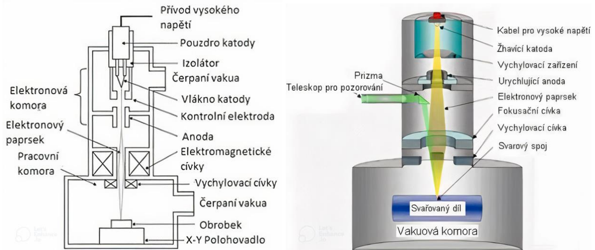
Obrázek 2-8 Schéma svařování elektronovým paprskem, převzato z [10]
