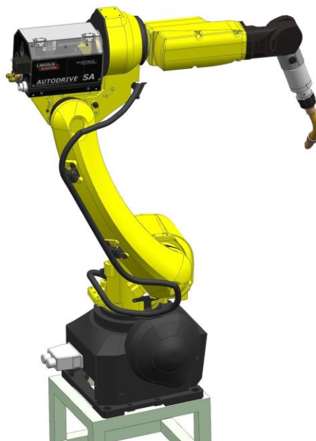
Obrázek 5-8 Svařovací robot Fanuc ARCMate100iD s MIG hořákem a podavačem drátu
