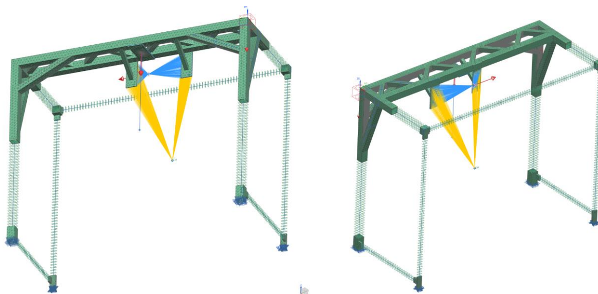
Obrázek 6-10 Definice výpočetního modelu rámu, pohled spodní zezadu a horní zřepředu
