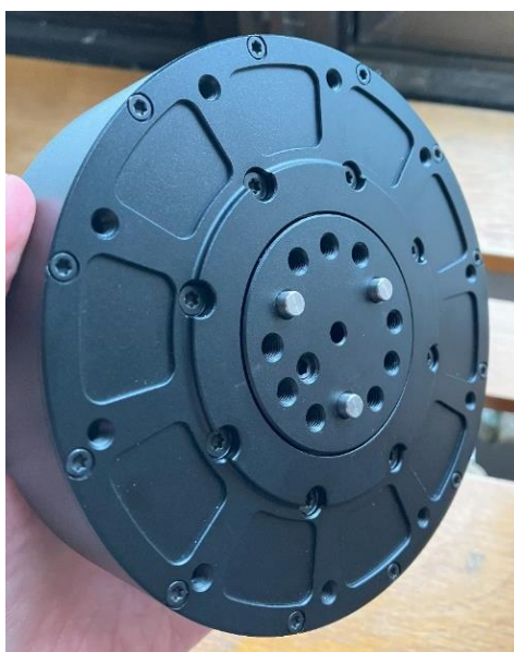
Obr. 63: Servomotor MG10015E-i10 v2 – zadní část
