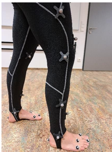
Obr. 43: Detailní záběr na rozložení markerů na dolních končetinách
