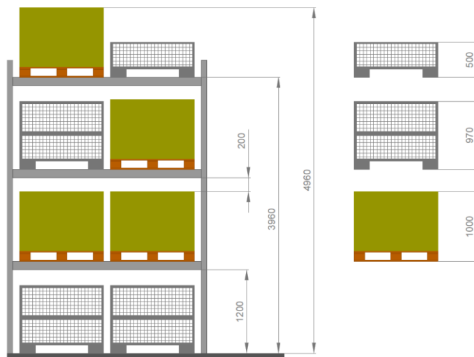
Obrázek 4-13: Uspořádání úrovní paletového regálu ve variantě 2
