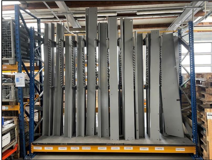
Obrázek 3-10: Vertikální regál pro dlouhé díly
