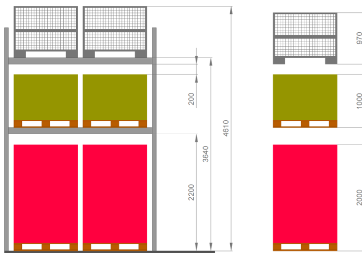
Obrázek 4-15: Uspořádání úrovní paletového regálu ve variantě č. 4
