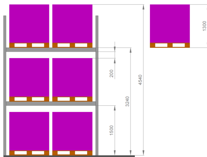
Obrázek 4-14: Uspořádání úrovní paletového regálu ve variantě 3
