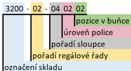
Obrázek 4-6: Systém označování paletových pozic
