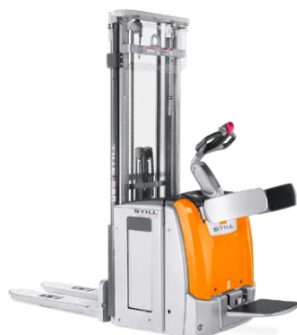
Obrázek 4-4: Ruční elektrický paletový vozík Still EXV-SF 14 [20]
