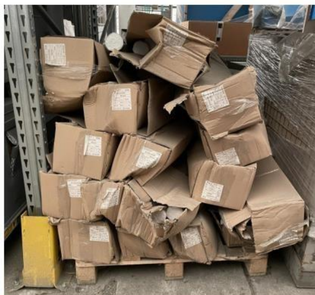
Obrázek 3-20: Nevhodně umístěný materiál na paletě
