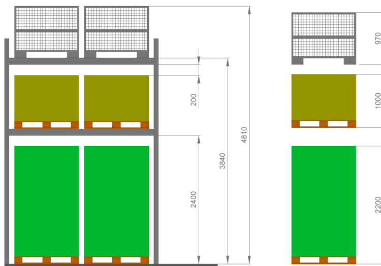
Obrázek 4-16: Uspořádání úrovní paletového regálu ve variantě 5
