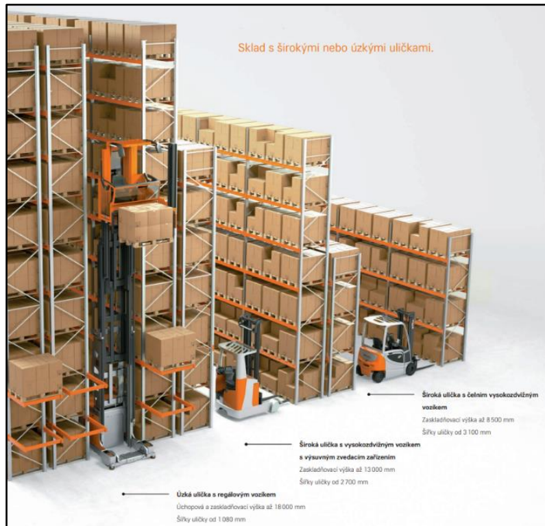
Obrázek 1-9: Návrh šířky uliček ve skladu [20]
