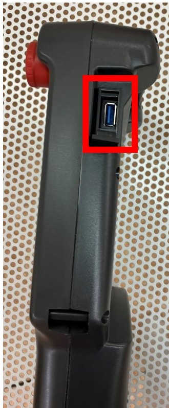
Obrázek 63: USB port na TeachPendantu reálného robota
