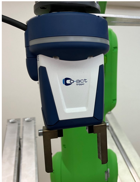
Obrázek 11: Koncový efektor robota pro uchopování z laboratoře KPV
