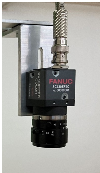
Obrázek 10: Senzor vidění robota z laboratoře KPV
