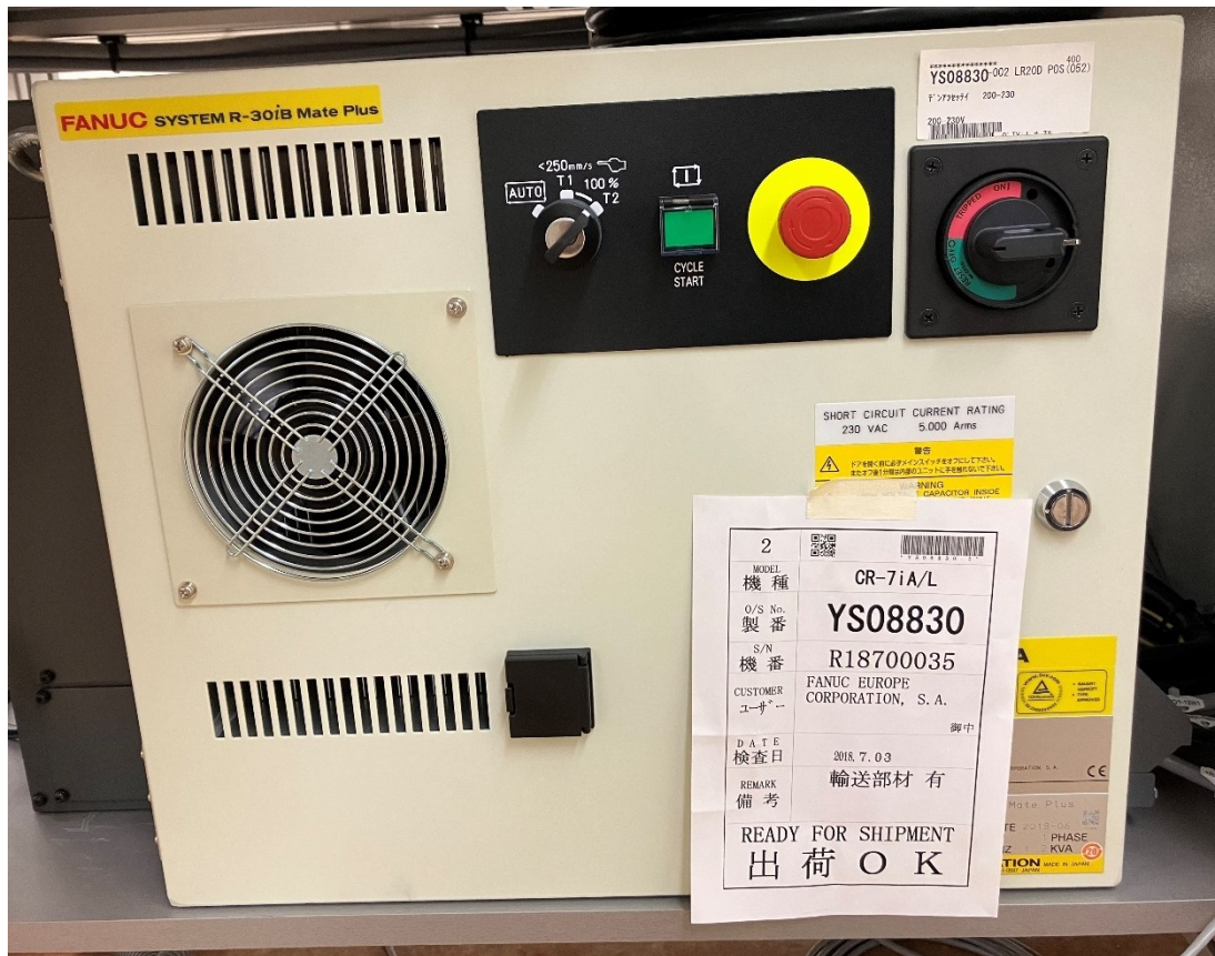
Obrázek 9: Řídící jednotka robota z laboratoře KPV
