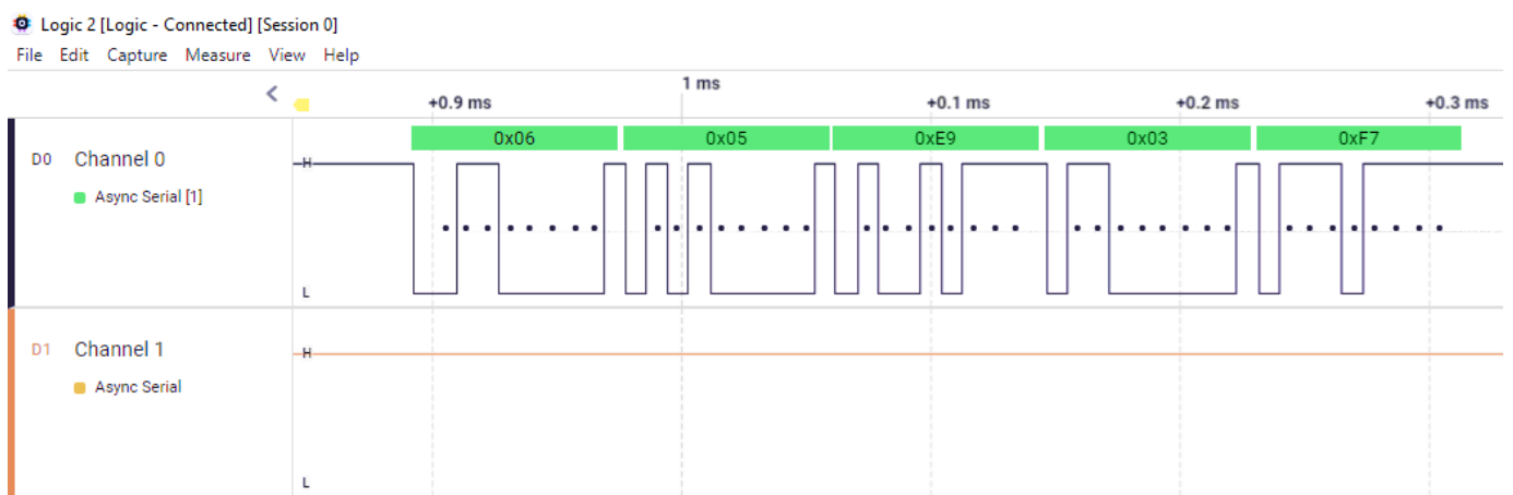
Obr. 20: Zachycení přijímací sekvence logickým analyzátořem
