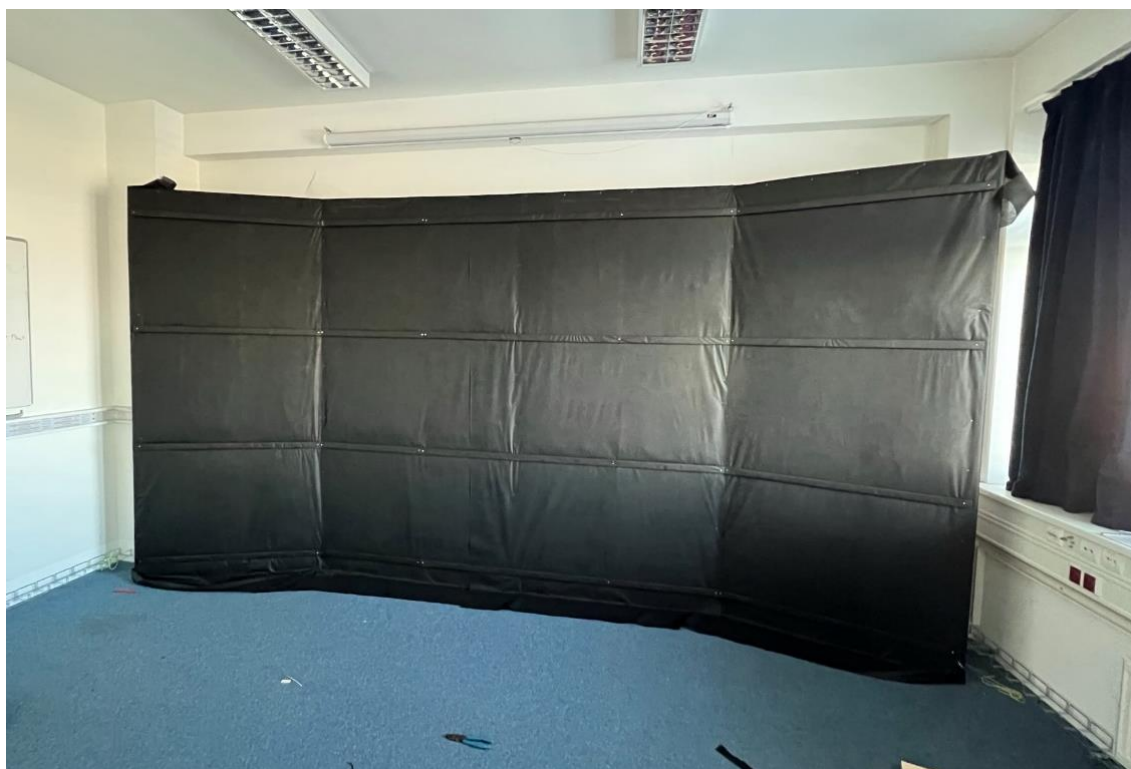
Obrázek 5-8: Foto rezonátoru vyplněného kamennou vatou a zakrytého netkanou textilií.
