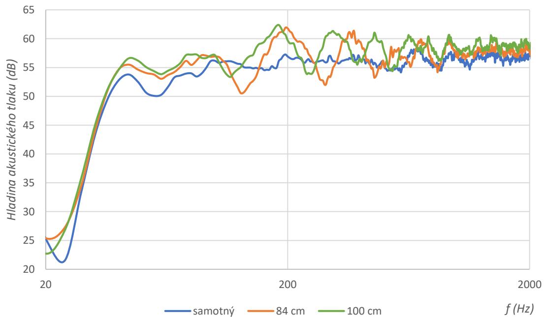
Obrázek 0-2: Vliv vzdálenosti reproduktoru od desky v bezodrazové komoře v 84 cm a 100 cm v porovnání s průběhem samotného reproduktoru bez desky.
