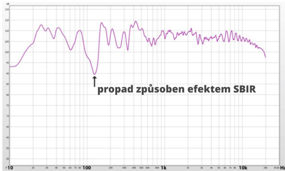
Obrázek 2-3: Měření frekvenční odezvy v místě poslechu ukazující pokles způsobený efektem SBIR Převzato z [7].
