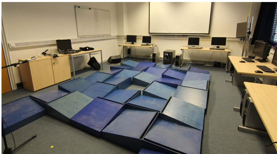
Obrázek 5-3: Foto pohltivých nízkofrekvenčních prvků
