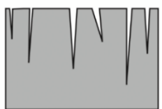
Obr. 4: Tvorba trhlin od tepelné únavy [4]
