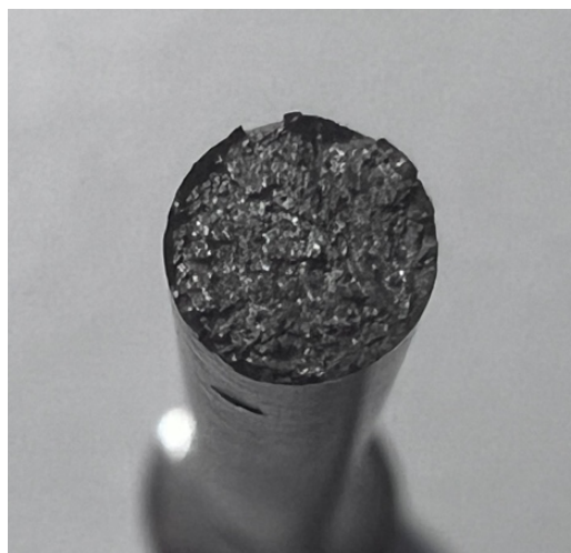
Obr. 46: Lom zkušebního tělesa 500°C / 4 hod
