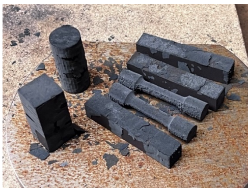
Obr. 25: Série 9 – 1 030°C / 30 min + 2x 500°C / 2 hod
