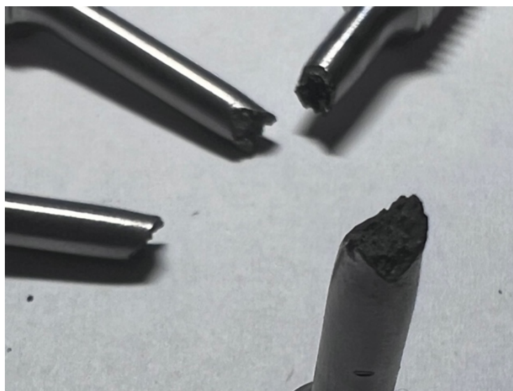
Obr. 48: Lom zkušebního tělesa 620°C / 4 hod
