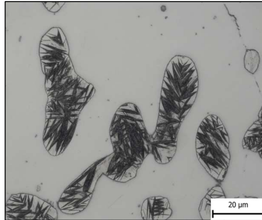
Obrázek 16: 6,5Al4Mn-příčný řez-obj. 100x
