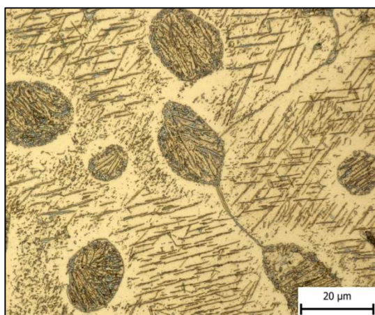
Obrázek 43: 6,5Al4Mn-popouštění 700 °C – obj. 100x_barevné leptání
