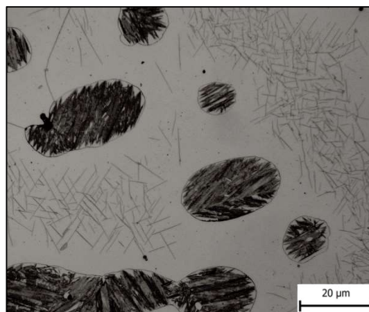
Obrázek 41: 6,5Al4Mn-popouštění 600 °C – obj. 100x
