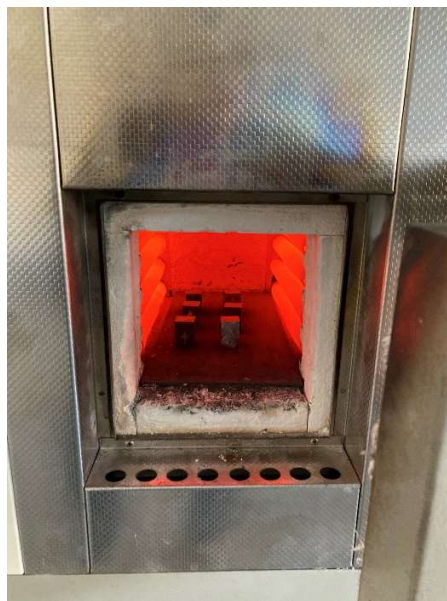
Obr. 30: Vzorky při vkládání do pece
