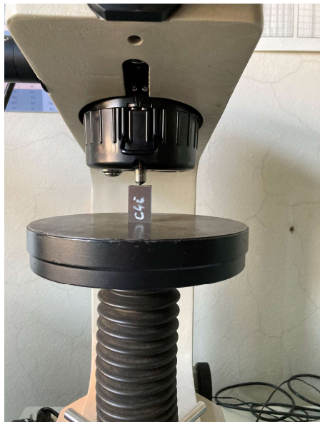
Obr. 27: Měření tvrdosti na přístroji Mitutoyo AVK
