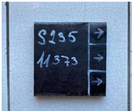
Obr. 25: Materiál S235 před rozřezáním
