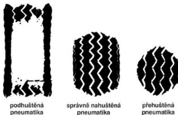
Obr. 1.6 Vliv tlaku na dotykovou plochu pneumatiky při styku s vozovkou. – převzato z [8]
