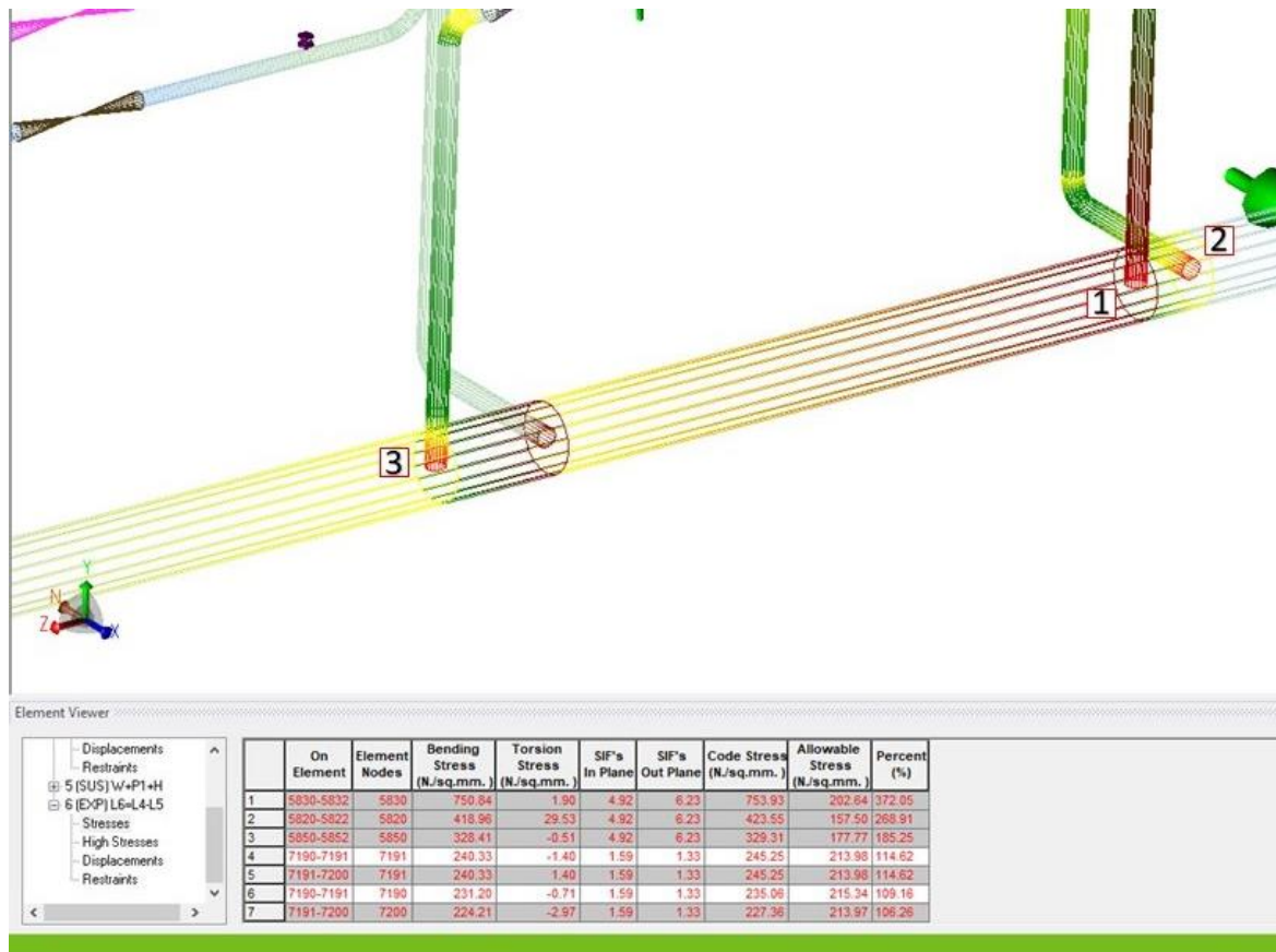
Obr. 27 - EXP zatížení detail připojovacích míst na 1LCN50BR001
