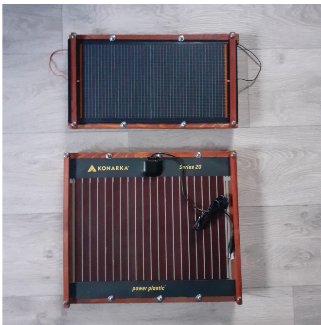
Obrázek 3.11: Dřevěné rámečky CIS a organického panelu
