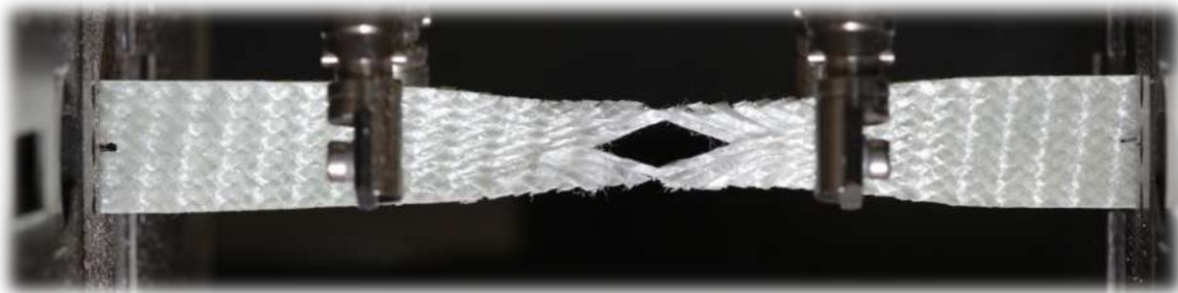
Obr. 3 Tahová zkouška – test vnějších potahů [2]
