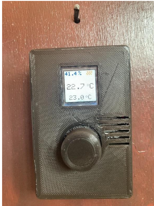
Obr.36: Vlastní chytrý termostat
