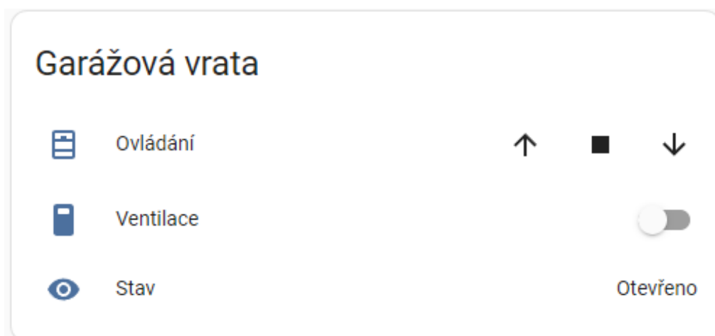
Obr.45: Rozhraní v Home Assistantu pro řízení vlastního chytrého ovládání garážových vrat/rolet
