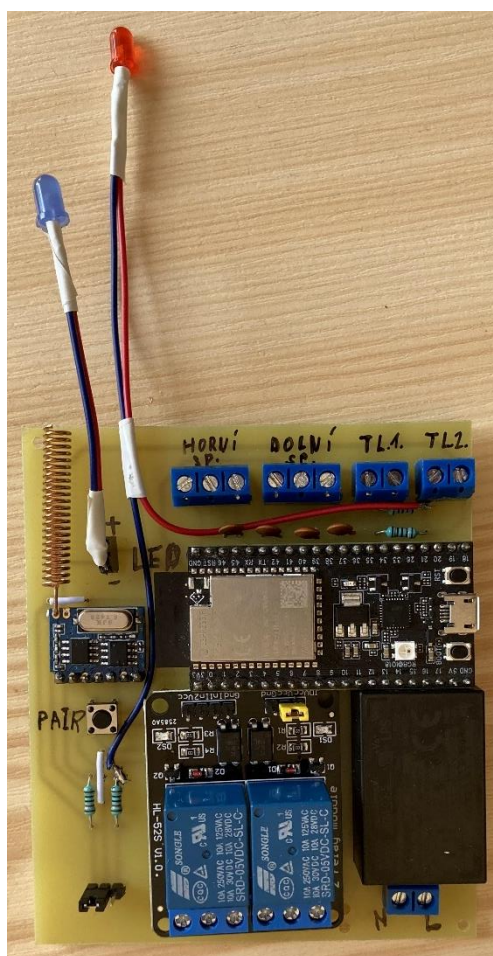
Obr.41: Osazené plošné spoje vlastního chytrého ovládání garážových
