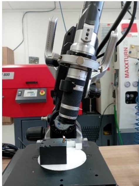
Obrázek 19 Měření opotřebení vyměnitelné břitové destičky
