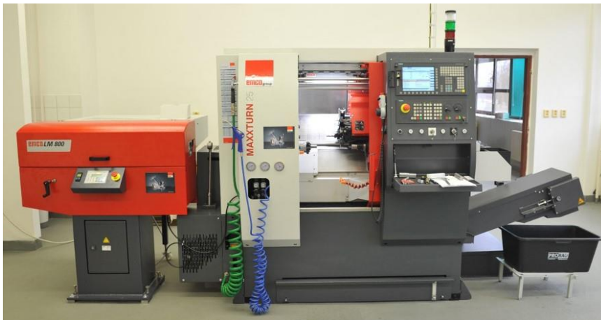
Obrázek 9 Soustruh EMCO MAXXTURN 25 [36]
