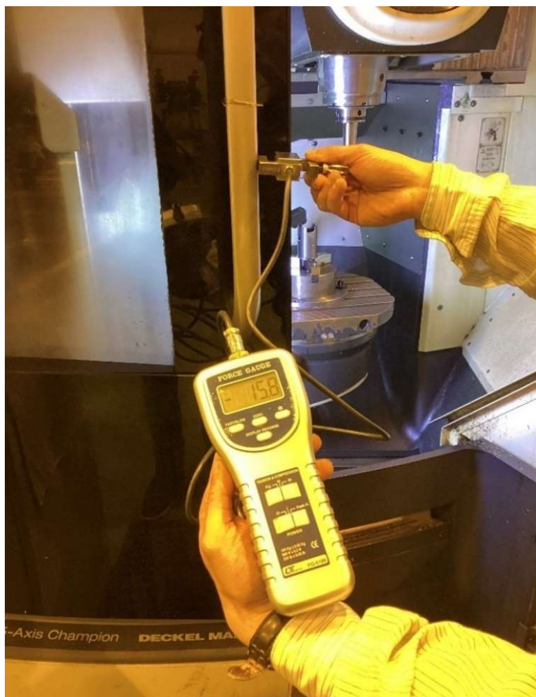
Obrázek 16: Měření tlačné síly + naměřená hodnota [17]
