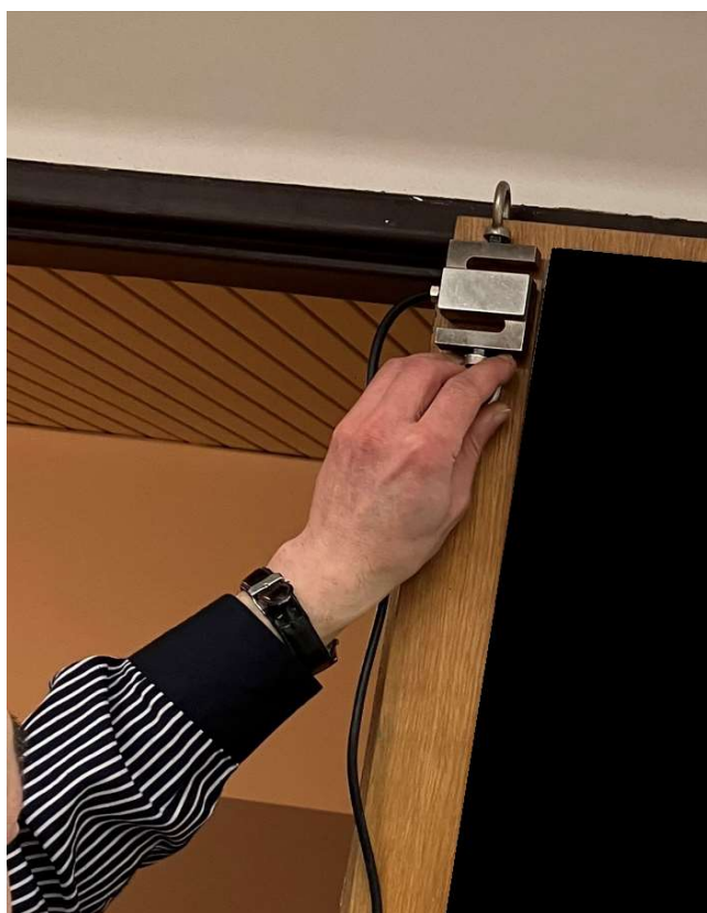
Obrázek 23: Měření maximální tažné síly směrem dolů [17]
