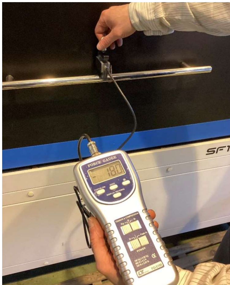
Obrázek 15: Měření tlačné síly + naměřená hodnota [17]
