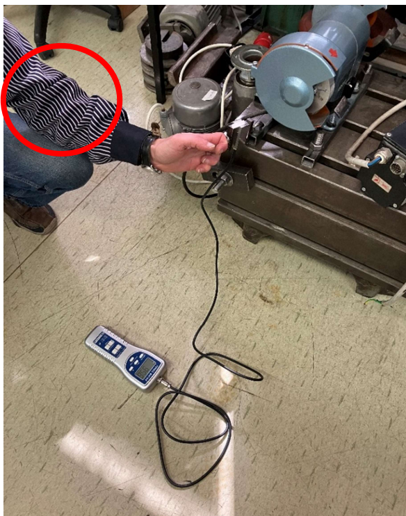
Obrázek 18: Měření maximální tlačné síly pokrčenou rukou [17]
