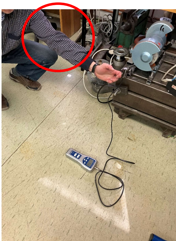
Obrázek 20: Měření maximální tažné síly nataženou rukou [17]
