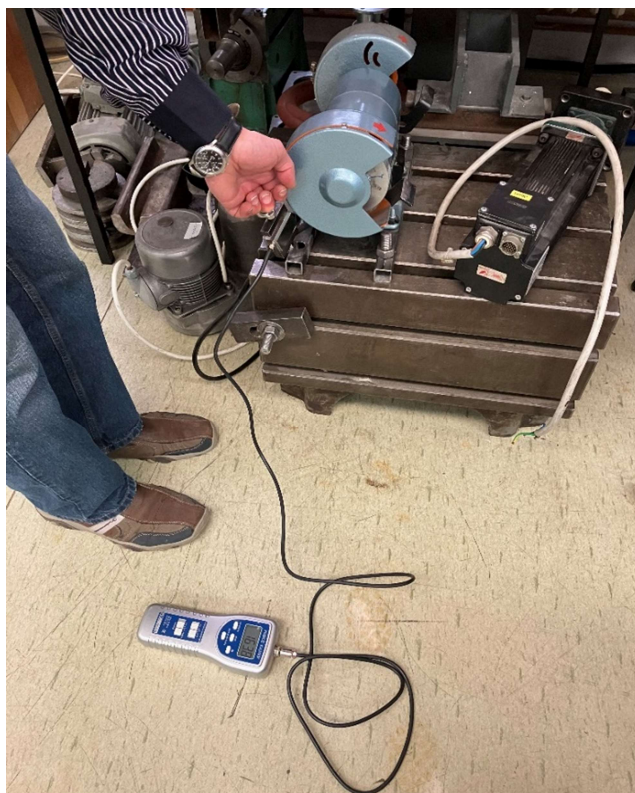
Obrázek 22: Měření maximální tažné síly směrem nahoru [17]
