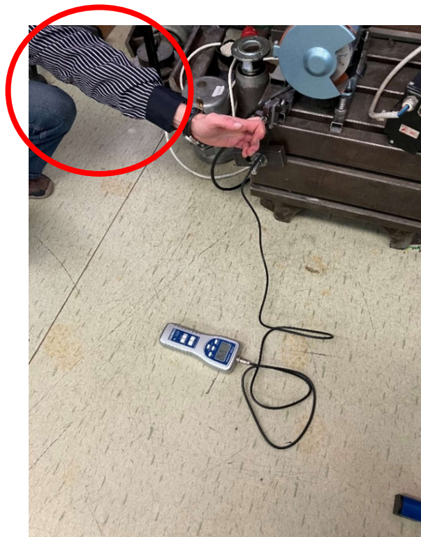
Obrázek 19: Měření maximální tlačné síly nataženou rukou [17]
