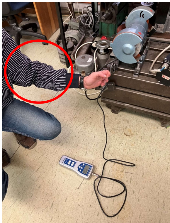
Obrázek 21: Měření maximální tažné síly pokrčenou rukou [17]
