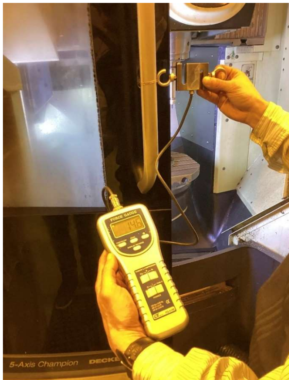
Obrázek 17: Měření tažné síly + naměřená hodnota [17]
