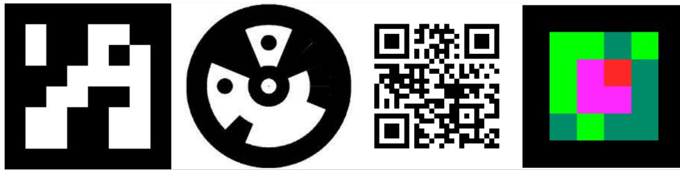
Obrázek 3: Ukázka různých typů optických značek. Zleva 1) ARuco [36] 2) Intersense [37] 3) QR code [Masahiro Hara, 1994, Japan] 4) ChromaTag [38]
