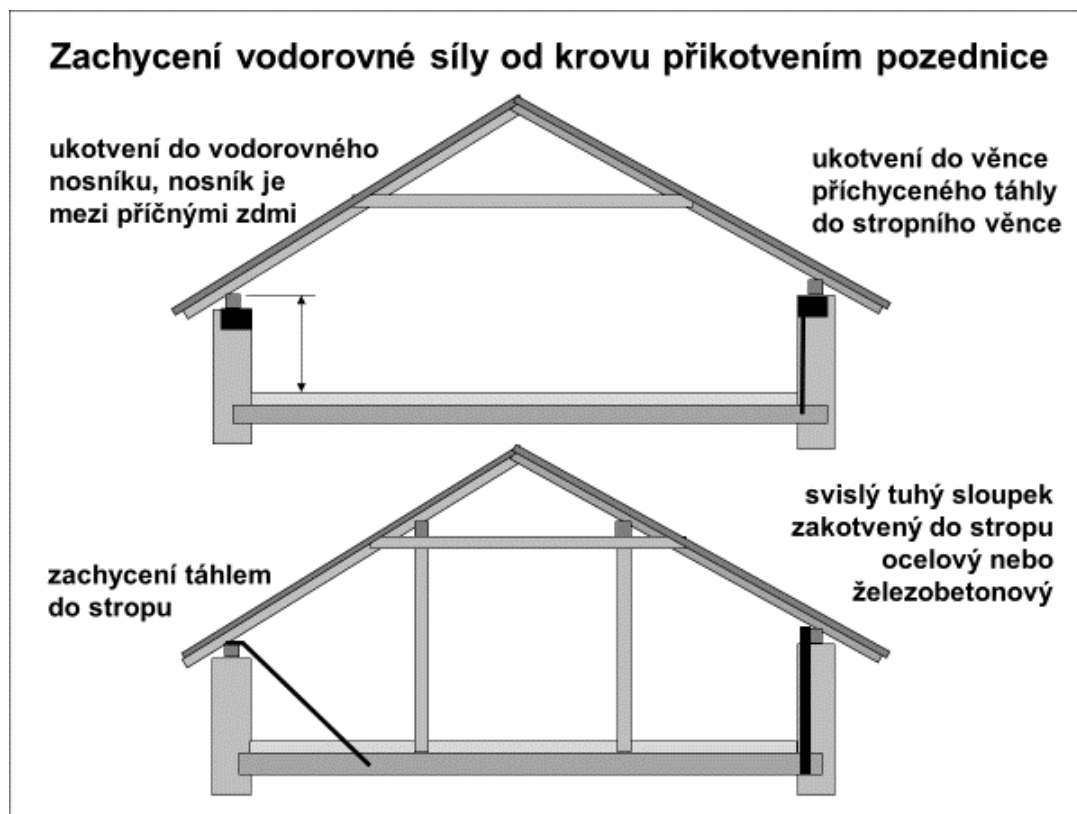
Obr. 34 – Možnosti zachycení vodorovné síly od krovu- čtyři možnosti (autor)
