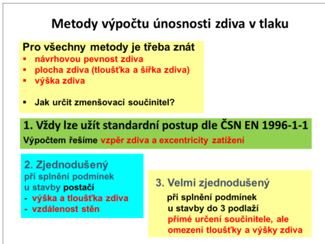
Obr. 50 – Znázornění metod výpočtu svislé únosnosti zdiva
