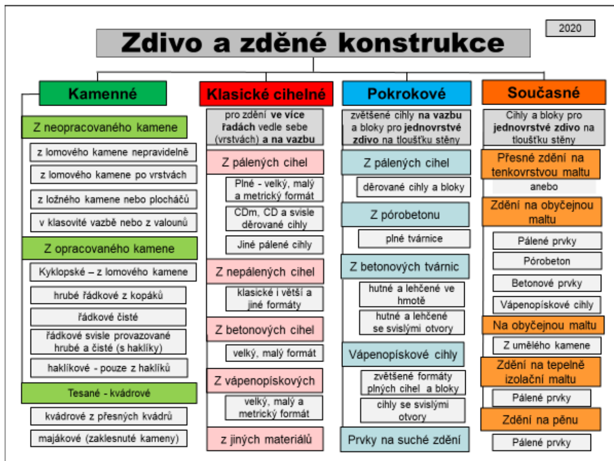
Obr. 4 – Typy zdiva podle materiálu a historie vzniku
