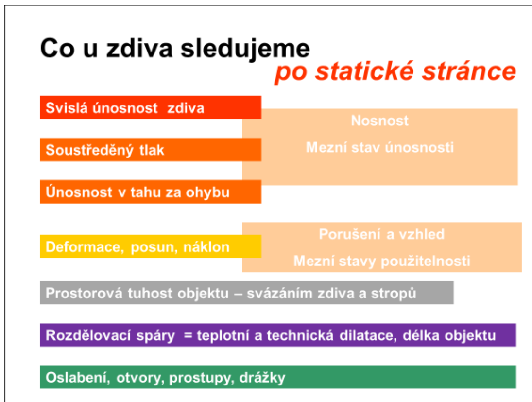
Obr. 49 – Schéma o tom, co u zdiva staticky navrhujeme
