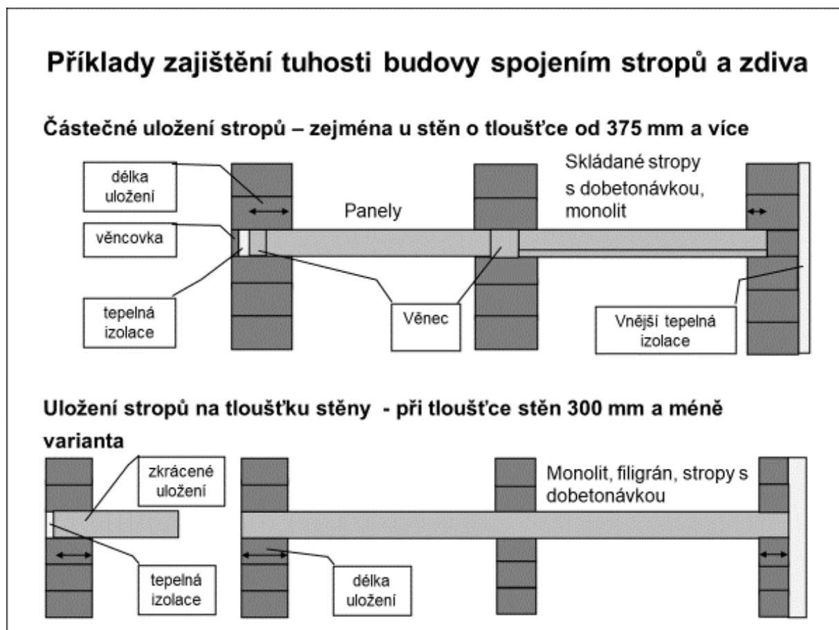
Obr. 28 – Schéma uložení stropní konstrukce na zdivo
