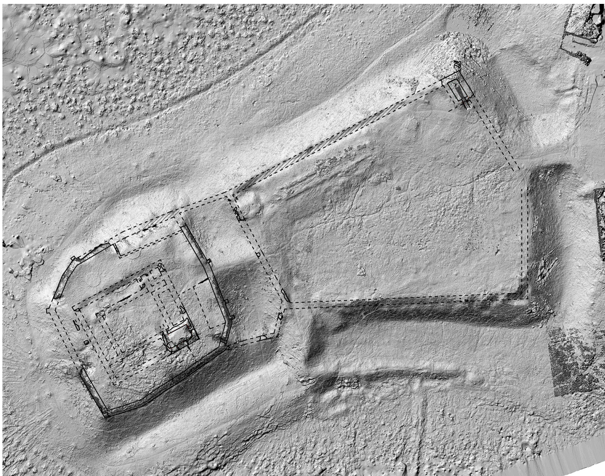
Obr. 5. Mapa numeryczna zamku wysokiego i przedzamcza I w Lipienku z naniesionymi relikami murów i rekonstrukcją ich przebiegu. Oprac. S. Tyszkowski, B. Wasik. – Abb. 5. Digitalmodell des Hochschlosses mit der Vorburg in Lipienek mit der Aufzeichnung des Mauerwerksverlaufs. Bearbeitet von S. Tyszkowski und B. Wasik.
