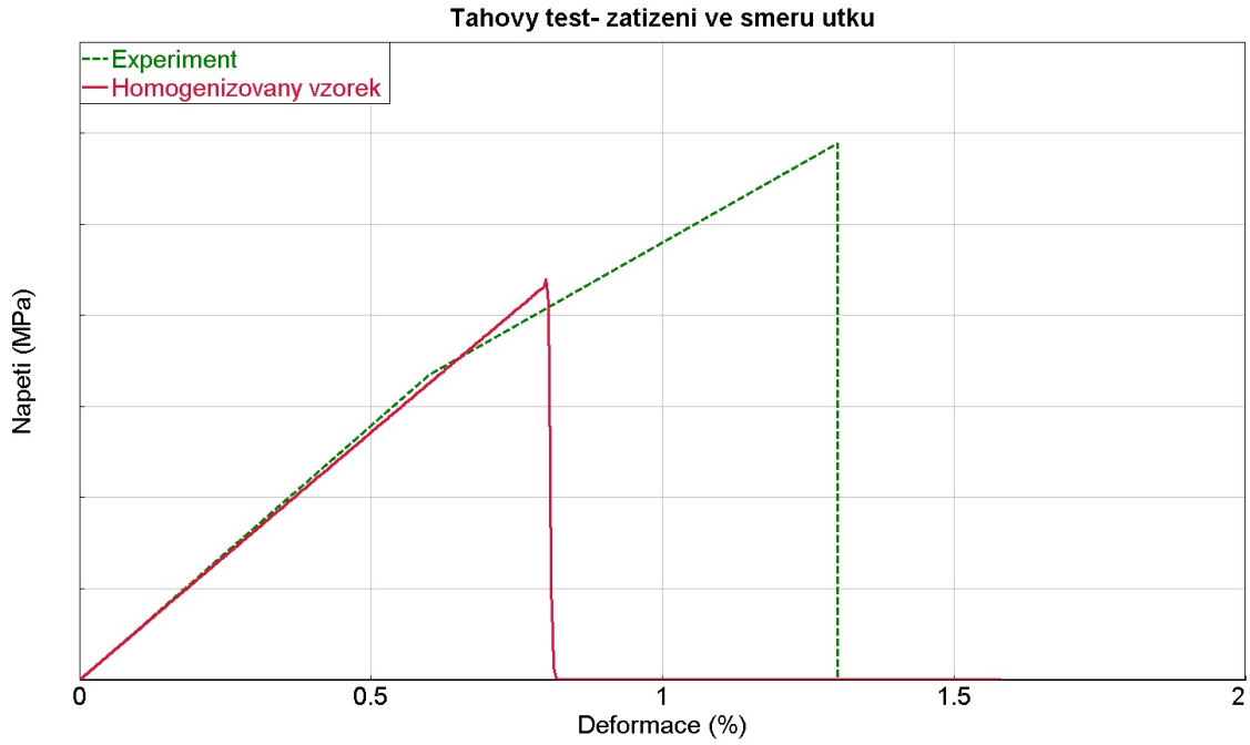
Obrázek 40: Porovnání závislosti napětí a deformace pro tahový test při zatížení ve směru útku
