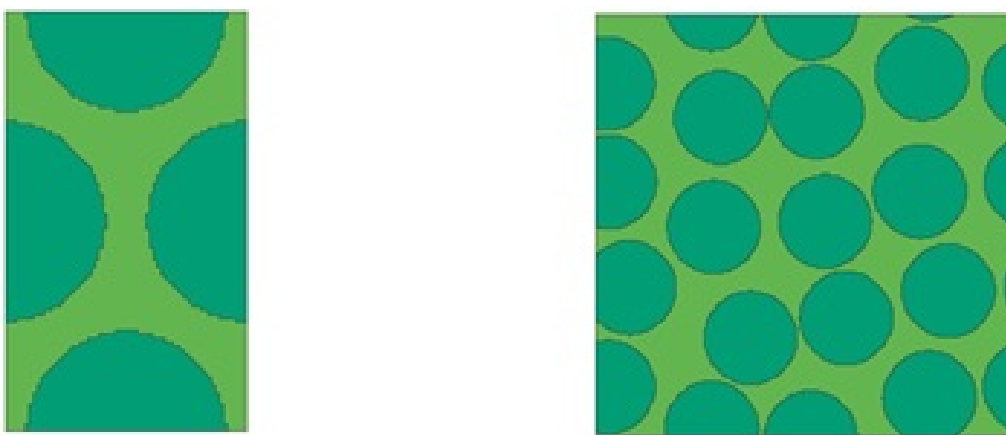
Obrázek 9: MKP síť s pravidelným rozložením vláken (vlevo) a náhodným rozložením vláken (vpravo)
