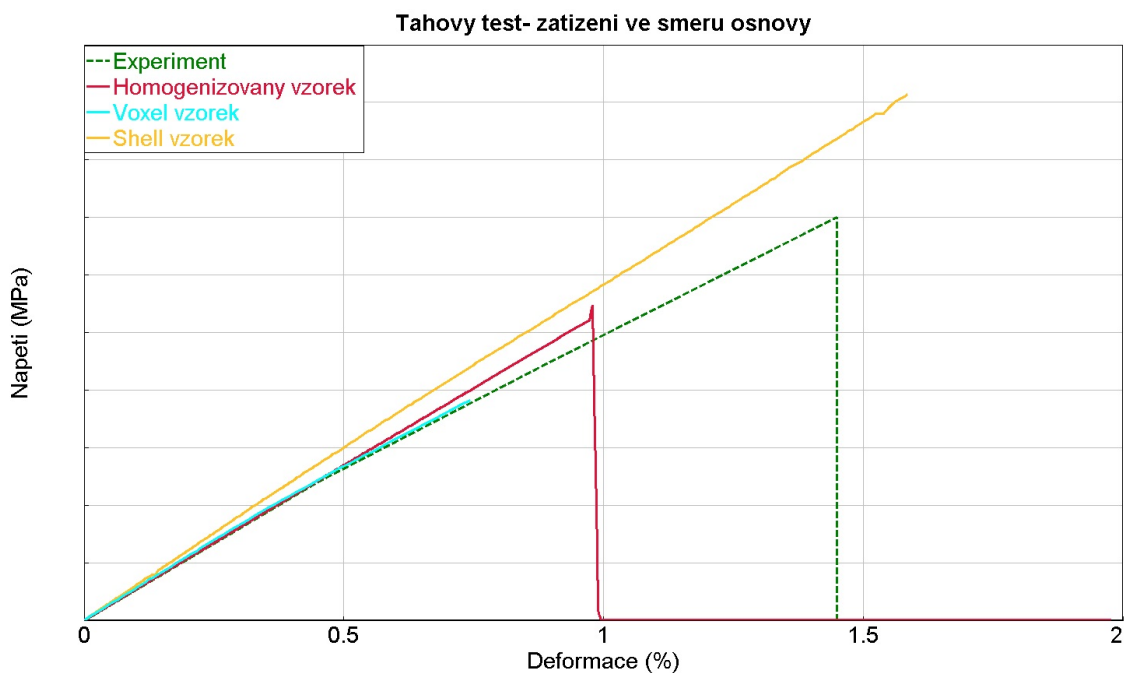
Obrázek 39: Porovnání závislosti napětí a deformace pro tahový test při zatížení ve směru osnovy
