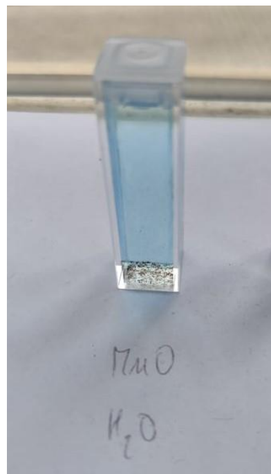
Obrázek 63 - MnO ablaované ve vodě, smíchané s MM, po 180 minutách testu
