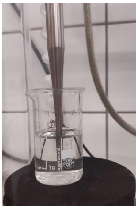
Obrázek 31 – Způsob vložení sondy ultra-sonifikátoru
