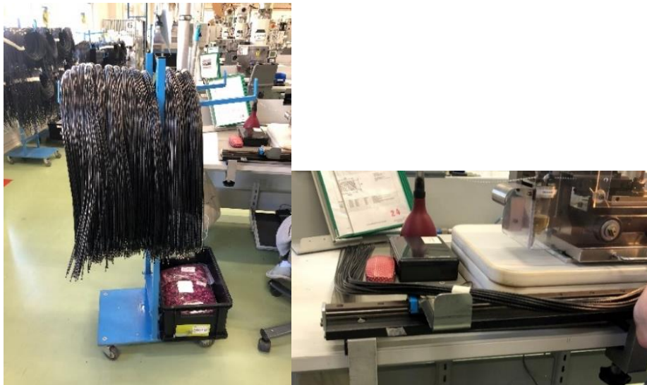
Obrázek 4.2 Levý stojan a držák na odkládání kabelů
