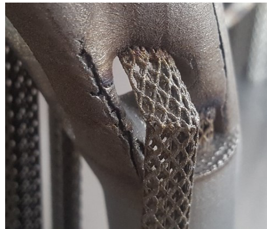
Obrázek 26 - Vznik trhliny vlivem zbytkového napětí kvůli přechodu z většího průměru na menší [14]
