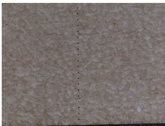
Obrázek 39 MS1-6- 490°C/6h - Kuličkování- 50x
