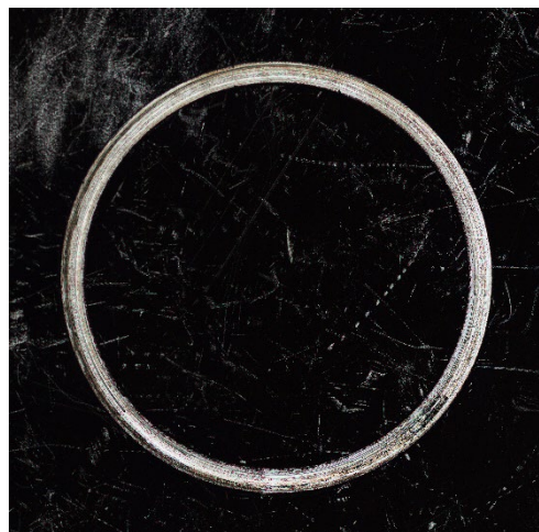
Obrázek 182 2.2 MS1 -940°C/2 h, 490°C/ 6 h- Nitridace
