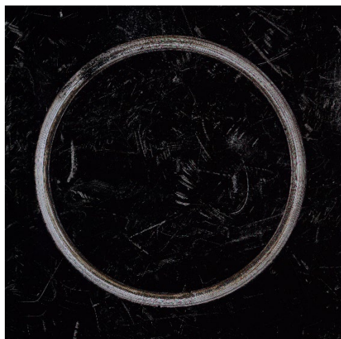
Obrázek 187 4.1 MS1 - 490°C/ 6 h- Nitridace
