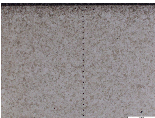
Obrázek 79 3. HO -1000°C/30 min, 500°C/ 2 h- Nitridace- 50x
