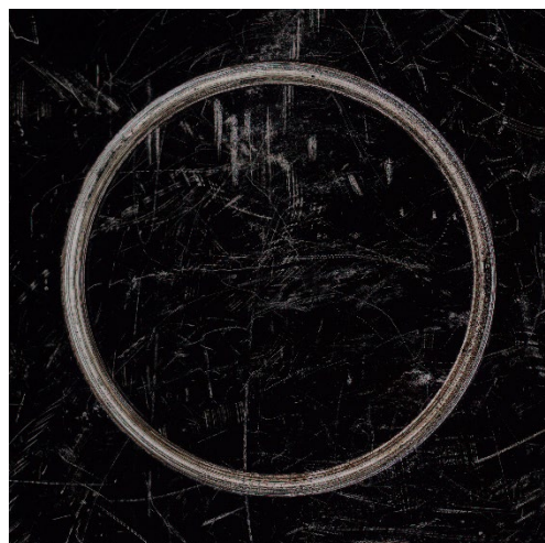
Obrázek 186 4.2 MS1 - 490°C/ 6 h- Nitridace
