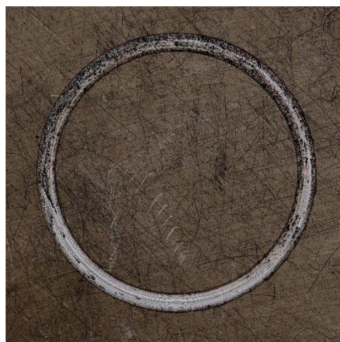
Obrázek 191 4. HO - 1000°C/30 min- Nitridace-S
