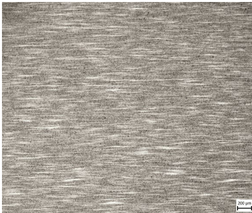
Obrázek 43HO- 950°C/30min, 350°C/2h-50x
