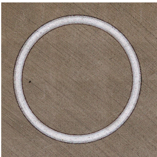
Obrázek 1933. HO -1000°C/30 min, 500°C/ 2 h- Nitridace-V
