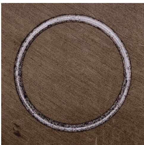
Obrázek 192 4. HO - 1000°C/30 min- Nitridace-V
