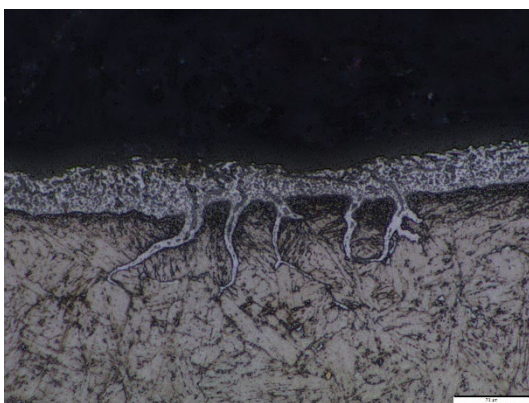
Obrázek 35 2. MS1 -940°C/2 h, 490°C/ 6 h- Nitridování-1000x
