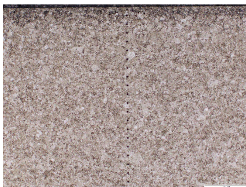
Obrázek 71 4. HO - 1000°C/30 min- Nitridace- 50x
