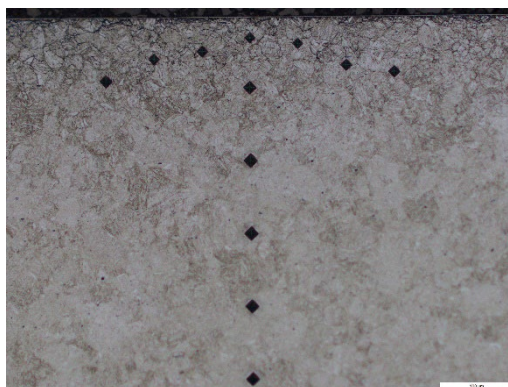
Obrázek 732. HO -1000°C/30 min, 250°C/ 2 h- Nitridace- 200x
