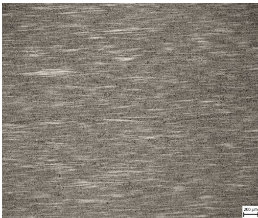
Obrázek 51HO- 1000°C/30min, 250°C/2h-50x
