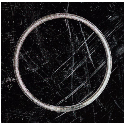
Obrázek 183 2.1 MS1 -940°C/2 h, 490°C/ 6 h- Nitridace
