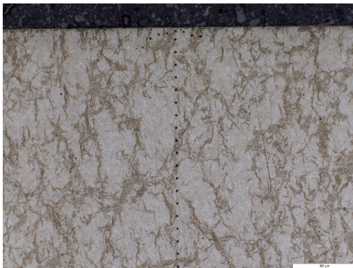
Obrázek 27 3. MSI -820°C/1 h, 490°C/ 6 h- Nitridace- 50x
