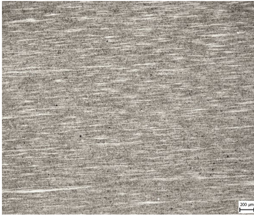
Obrázek 55HO- 1000°C/30min, 350°C/2h-50x
