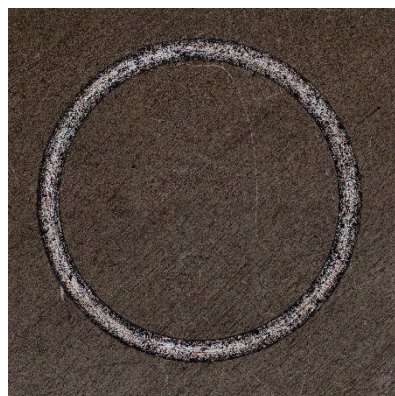
Obrázek 188 2. HO -1000°C/30 min, 250°C/ 2 h- Nitridace-S
