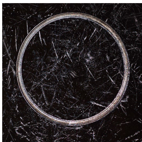
Obrázek 180 1.2 MS1 -Výchozí stav- Nitridace
