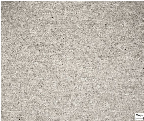
Obrázek 59HO- 1050°C/30min, 250°C/2h-50x
