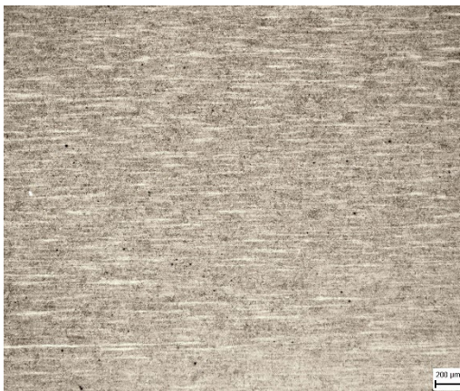
Obrázek 63 24HO- 1050°C/30min, 350°C/2h-50x
