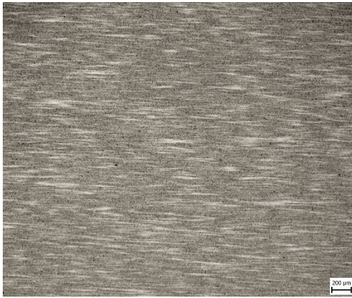
Obrázek 47 HO- 950°C/30min, 250°C/2h-50x
