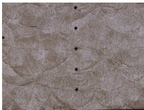
Obrázek 37 MS1-6- 490°C/6h - Kuličkování- 200x
