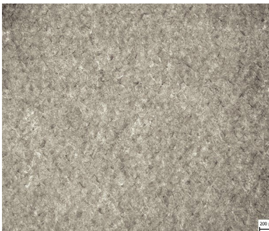
Obrázek 7MS1- 3.1 Precipitace 490°C/6 h - 50x
