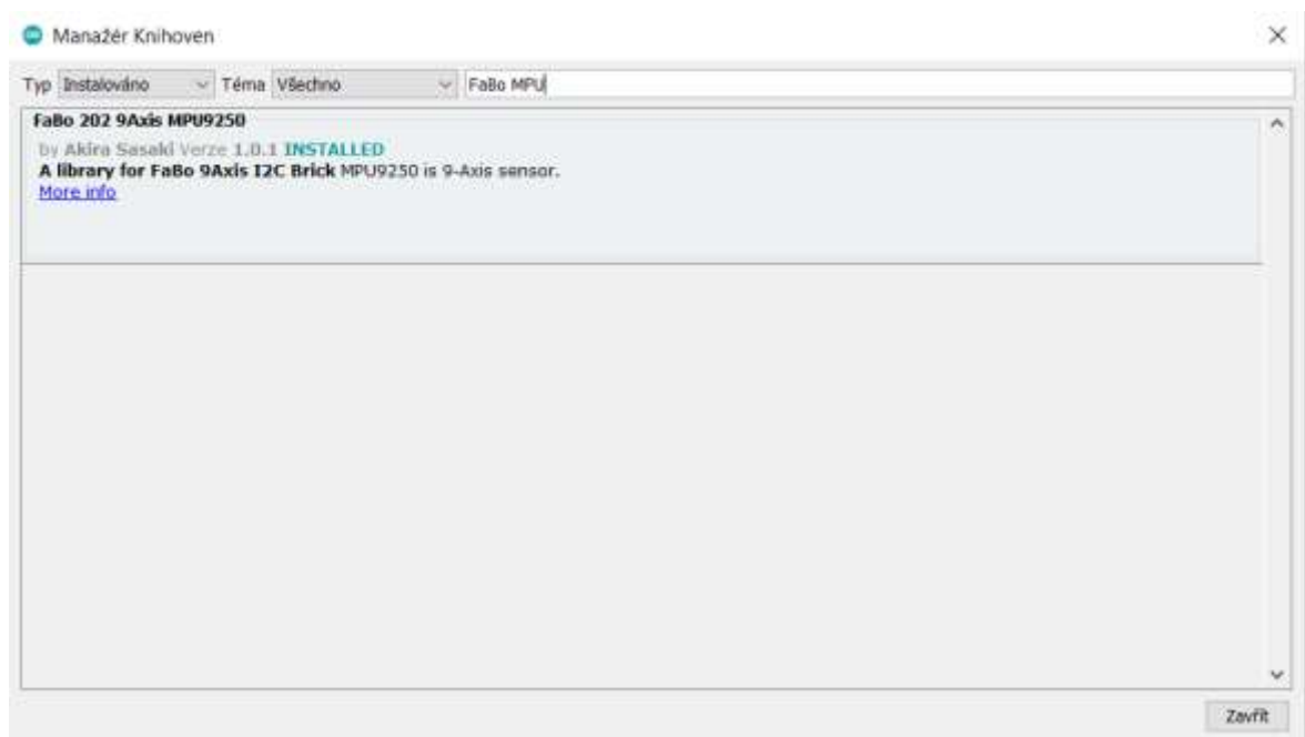
Obr. 4.1: Instalace knihoven v Arduino IDE
