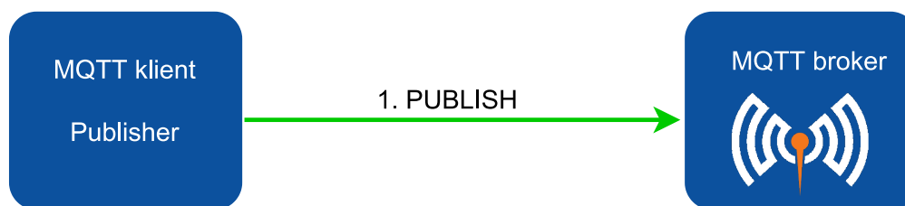
Obr. 3 MQTT úroveň služeb „QoS 0“ [15]
