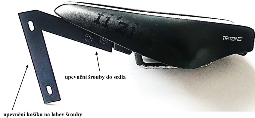
Obr. 17: První vytištěný prototyp úchytky z plastu na 3D tiskárně připevněný k sedlu
