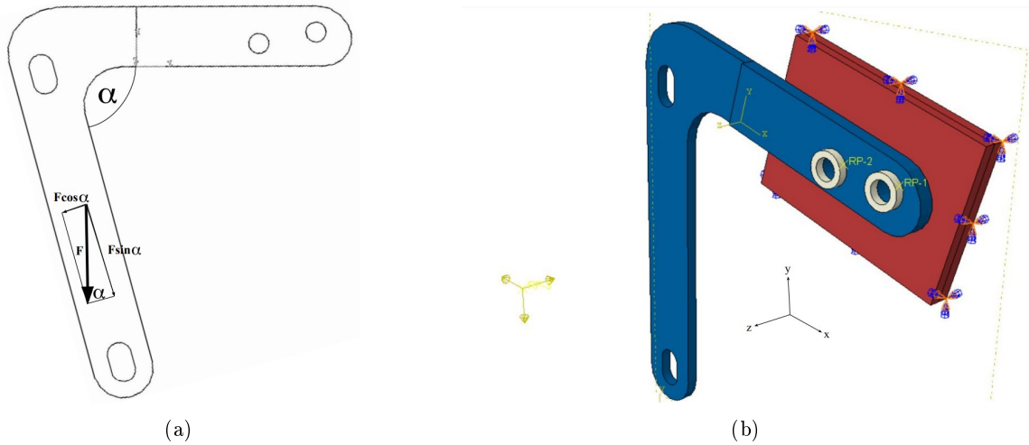
Obr. 19: Rozložení síly na úchytce ve směru x, y (a), síla ve směru z a vetknuté sedlo (b)
