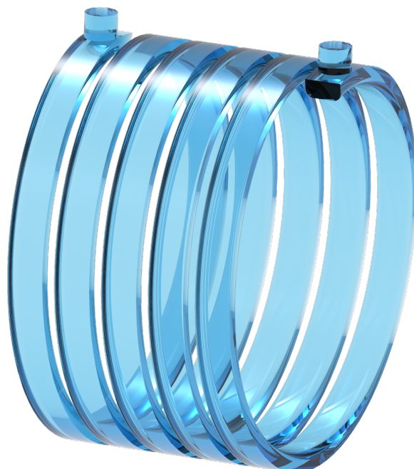
Obrázek 3.5: chladič v obdélníkové drážce
