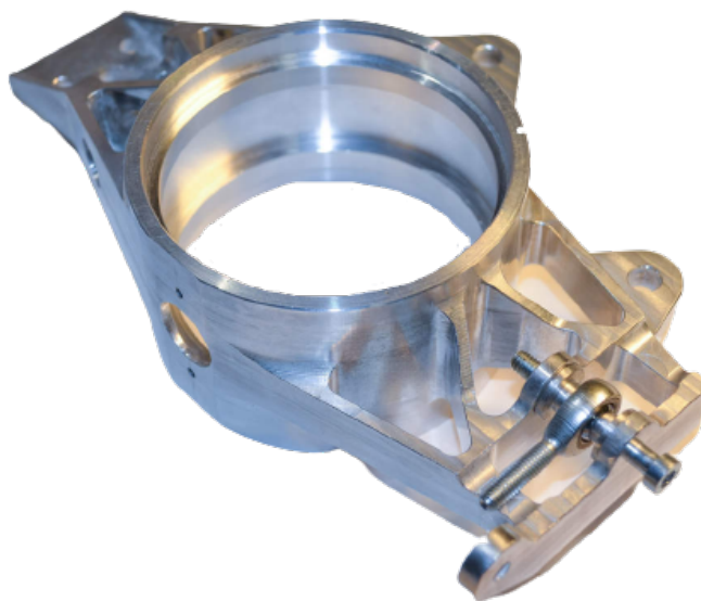
Obrázek 2.4: obráběná těhlice týmu Bauman [29]
