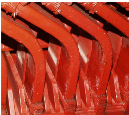
Obr. 8 Částečně porušený povlak (zdroj: [38])
