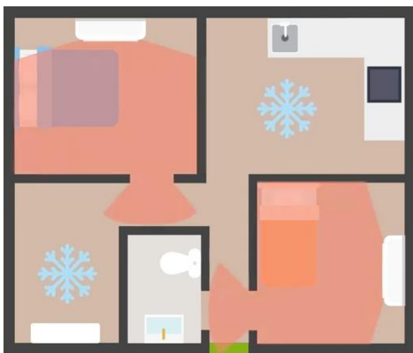
12. Obrázek - Problematika šíření teplého vzduchu z tepelného čerpadla vzduch-vzduch [15]
