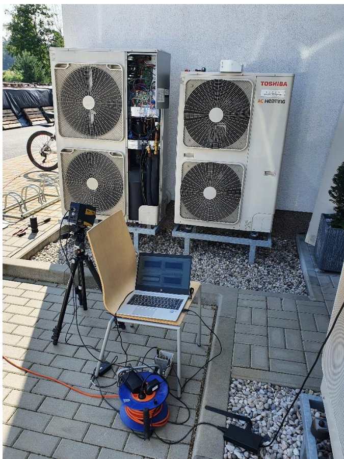
16. Obrázek - Měřicí pracoviště – vlevo Convert AW28-3P a vpravo Convert AW19-3P
