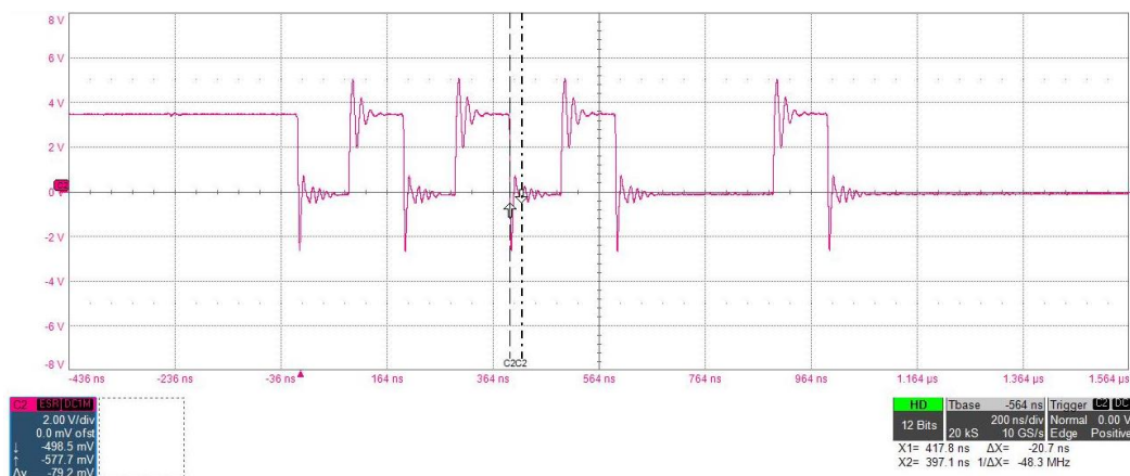
Obr. 32.: Kmitající přenos na sériové sběrnici (měřeno u FPGA)
