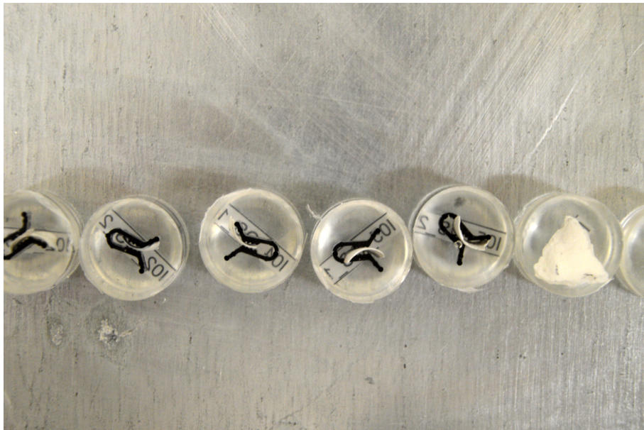
Obr. 7.9: Vzorčky připravené pro SEM/EDX analýzu.
