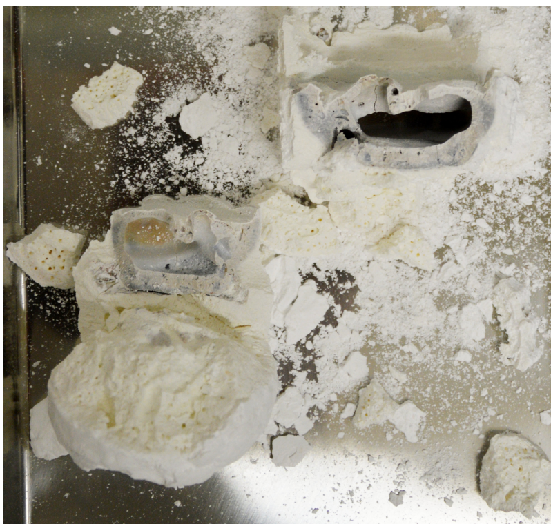
Obr. 7.13: Rozbitý ingot z experimentu I01.
