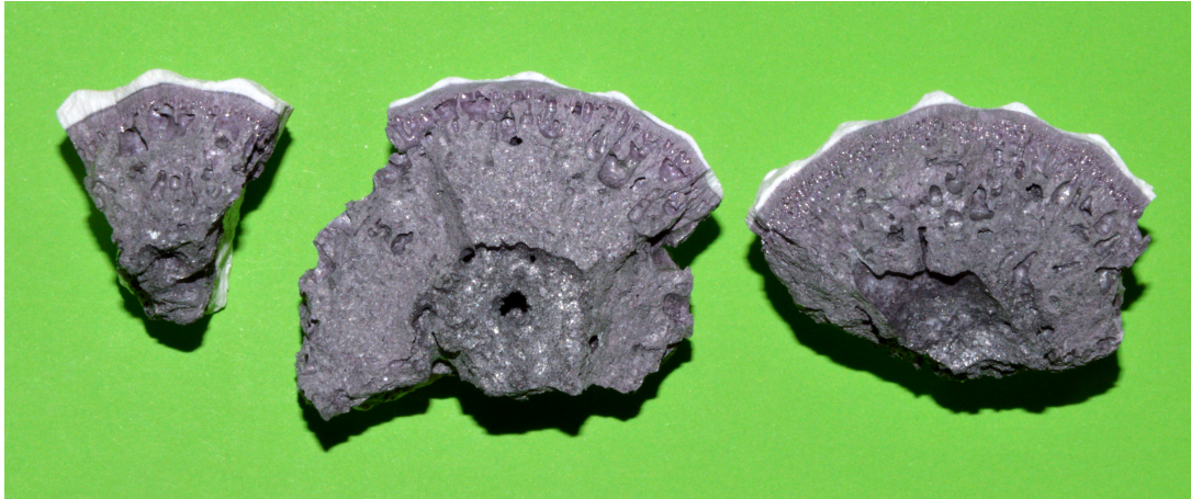
Obr. 5.2: Horizontální řez ingotem po experimentu v různých vzdálenostech ode dna studeného kelímku, kde kapalná fáze byla obarvena přidáním \text{Cr}_2\text{O}_3 .
