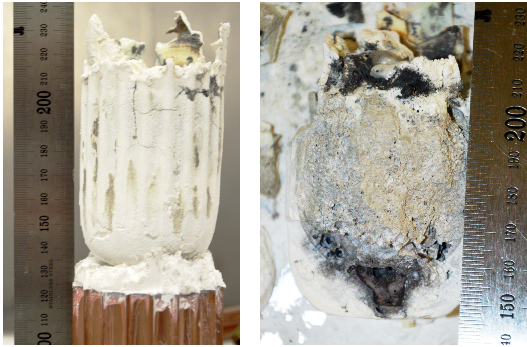
Obr. 7.22: Ingot z experimentu I03 po rozebrání studeného kelímku (vlevo) a po rozpůlení (vpravo).
