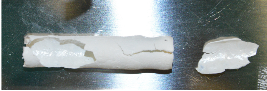
Obr. 7.8: Vzorek QS1 odebraný v průběhu experimentu I04 při teplotě 2100 °C.
