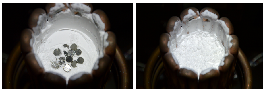
Obr. 3.11: Startovací materiál umístěný ve studeném kelímku (vlevo) a překrytý vrstvou práškové směsi (vpravo).
