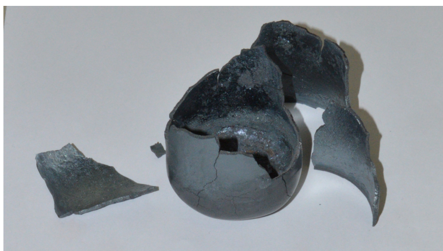
Obr. 7.75: Krusta odstraněná z kalorimetru po experimentu T01.
