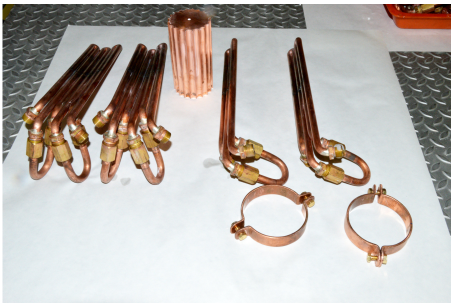
Obr. 3.6: Rozebraný studený kelímek před sestavením pro experiment.
