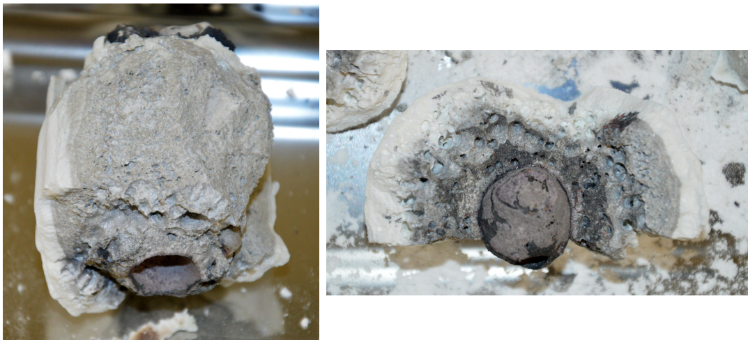
Obr. 7.23: Pohled na spodní část ingotu z experimentu I03 bez skull vrstvy (vlevo) a na měď usazenou ve spodní části ingotu (vpravo).
