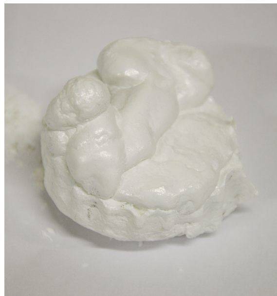
Obr. 7.54: Ingot získaný z experimentu I13 na neroztavené směsi po rozebrání studeného kelímku (vlevo) a samostatně (vpravo).
