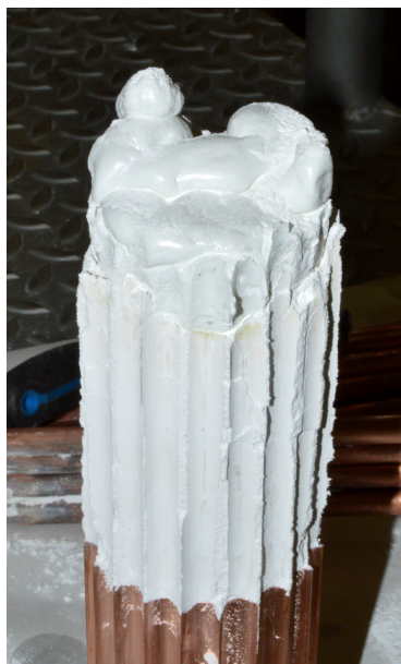
Obr. 7.54: Ingot získaný z experimentu I13 na neroztavené směsi po rozebrání studeného kelímku (vlevo) a samostatně (vpravo).
