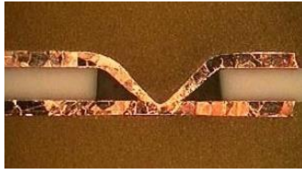
Obr. 4: Propojení měděných vrstev svařením skrz díru v keramice [14].
