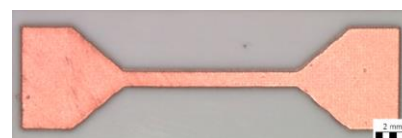
Obr. 26: Měděný motiv pro měření proudové zatížitelnosti.
