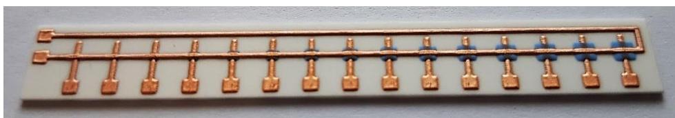
Obr. 39: Realizovaný testovací motiv D – přetisk vyvýšených částí dielektrika o různé velikosti.
