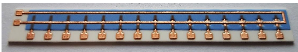
Obr. 41: Realizovaný testovací motiv E – tisk do prohlubní v dielektriku o různé velikosti.
