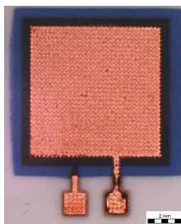
Obr. 36: Detail vzorku pro měření elektrických parametrů.
