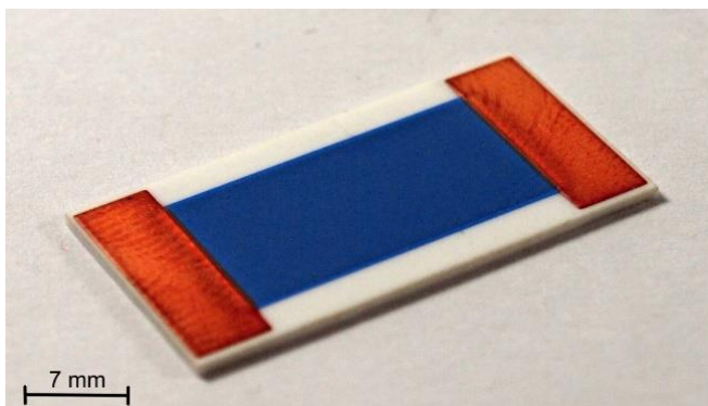
Obr. 76: Realizovaný vzorek rezistoru s měděnými vývody.
