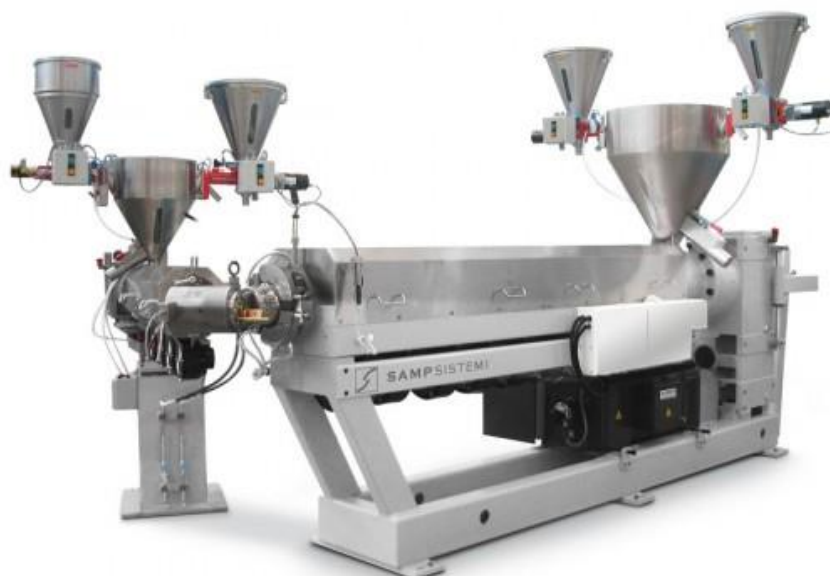
Obr. 3: Extruzní linka k izolování holých vodičů polymerními materiály vyráběný firmou Sampsistemi (převzato z [12]).
